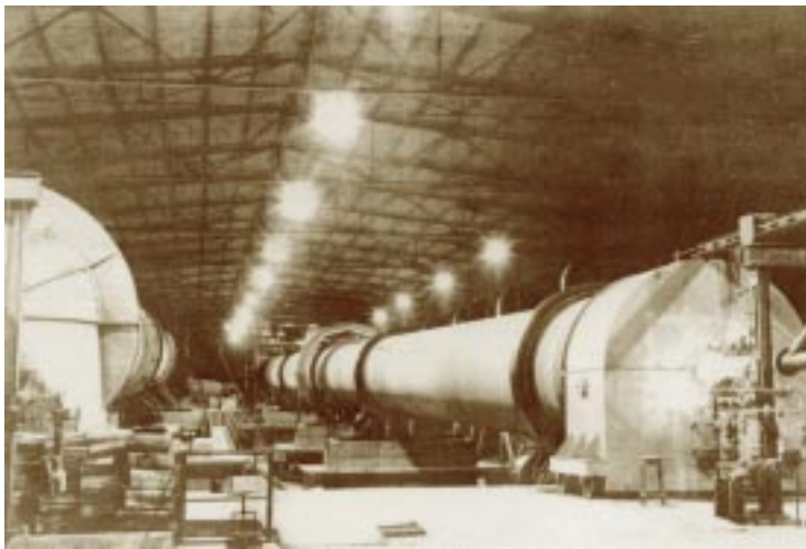
เตาเผาปูนของโรงงาน ชลประทานซีเมนต์ ที่ตากลิ
