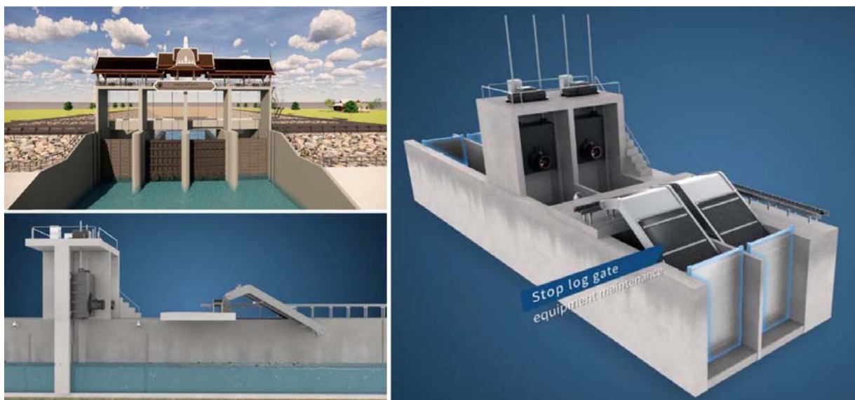
รูปที่ 3-18 ลักษณะการปรับปรุง ปตร. DR.2.8 ด้วย GatePump
