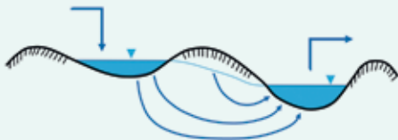
(9) การเติมน้ำและบำบัดผ่านชั้นดินและชั้นหินอุ้มน้ำ (Soil Aquifer Treatment)
