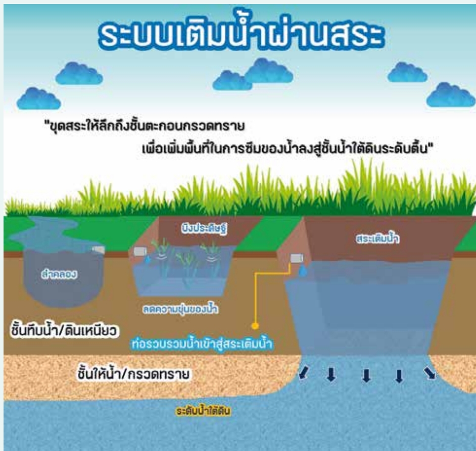
รูปที่ 5.1 ตัวอย่างระบบเติมน้ำใต้ดินระดับตื้นผ่านสระ
