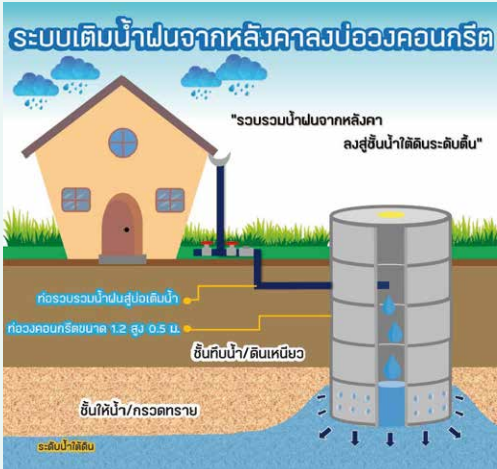
รูปที่ 5.5 ตัวอย่างระบบเติมน้ำใต้ดินระดับตื้นด้วยระบบหลังคาน้ำฝนผ่านบ่อวงคอนกรีต
