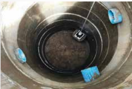
(3) ปากเก็บตะกอนจะ้าออก เมื่อถึง ผิวหน้าตะกอนปากจึงจะปิด
