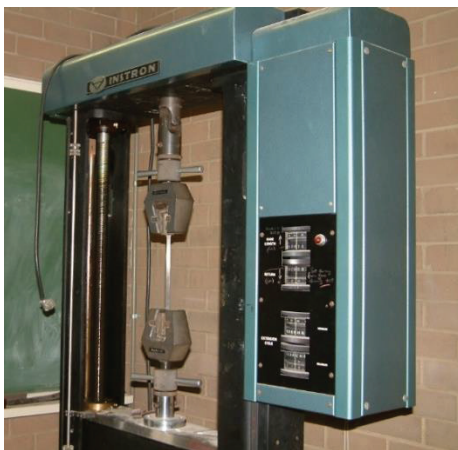
รูปที่ 1-12 การทดสอบความเค้นและความเครียดดึงของ CFRP [3]
