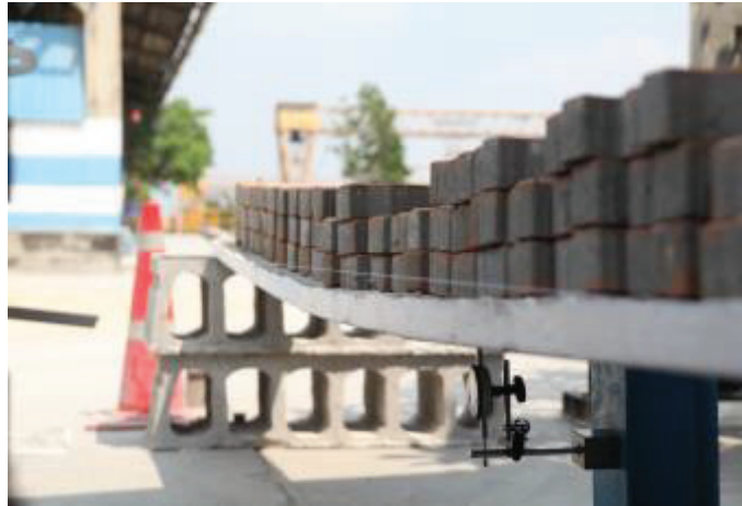
รูปที่ 8-21 การติดตั้งอุปกรณ์และการทดสอบหาค่าการโก่งตัวของแผ่นพื้นสำเร็จรูป [7]
