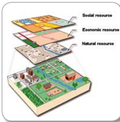
ภาพที่ 4.5 การจัดเก็บข้อมูลในรูปแบบของชั้นข้อมูลในระบบสารสนเทศภูมิศาสตร์
