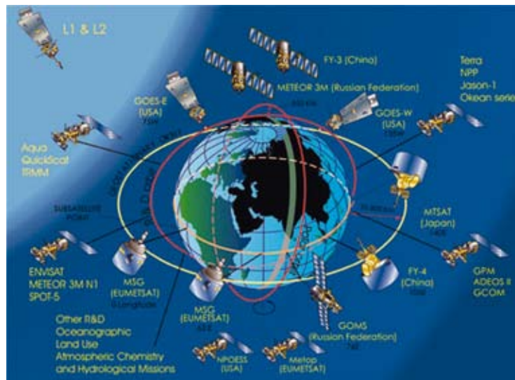
ภาพที่ 3.11 วงโคจรและตำแหน่งดาวเทียมอุตุนิยมวิทยา
