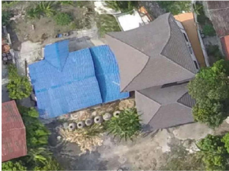
รูปที่ 9-34 ภาพตัวอย่าง Orthophoto ที่มีความผิดเพี้ยน
