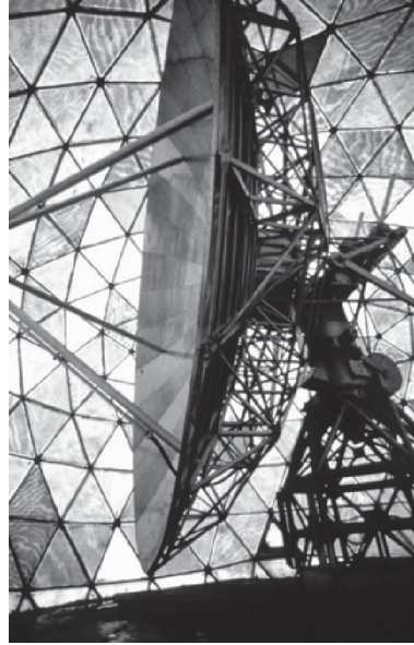
รูปที่ 8-1 NEXRAD (WSR-88D) เสาอากาศพาราโบลามองจากภายในราโดม (Bedient et al., 2019)
