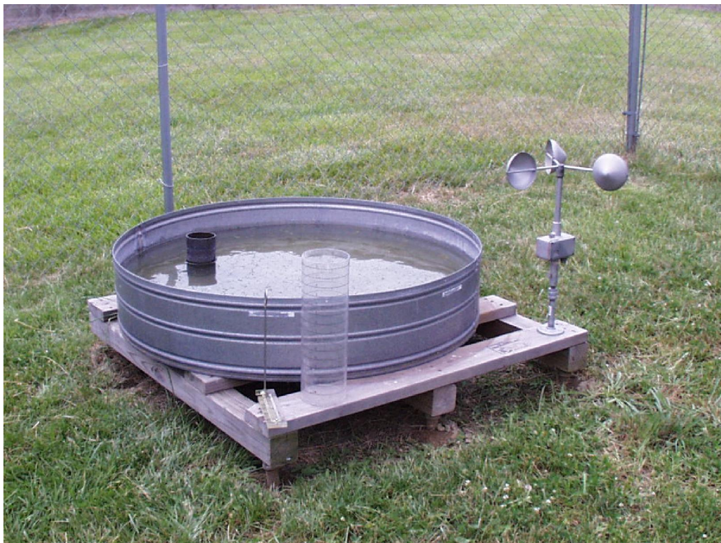
รูปที่ 1-18 ภาควัดการระเหยมาตรฐานที่มีเครื่องวัดฝนและวัดความเร็วลม (Bedient et al., 2008 และวิชูวัฒน์, 2556)
