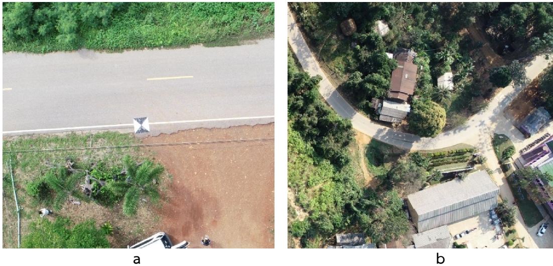
รูปที่ 9-17 ชนิดจุดควบคุมภาพถ่าย (a) การกำหนดจุดควบคุมภาพถ่ายโดยการทำเครื่องหมาย (b) ลักษณะภูมิประเทศที่ปรากฏบนภาพถ่ายที่สามารถชี้จำแนกได้ (มนทิตรา & วิษุวัตม์, 2562)
