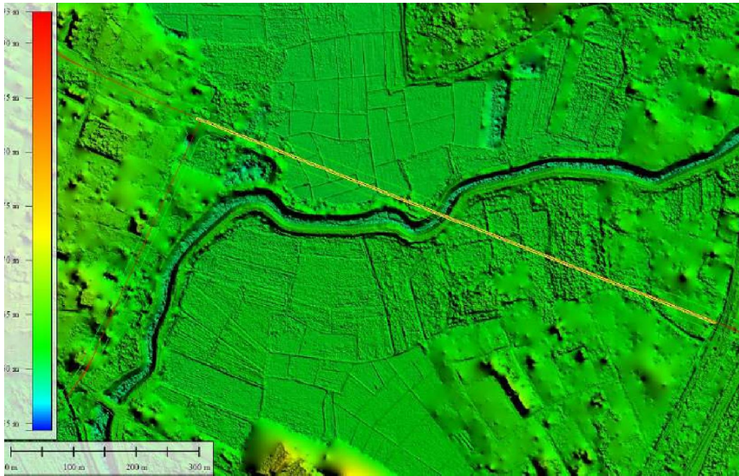
รูปที่ 9-39 ตัวอย่างการใช้ DEM ในการผลิต Profile & Cross section
