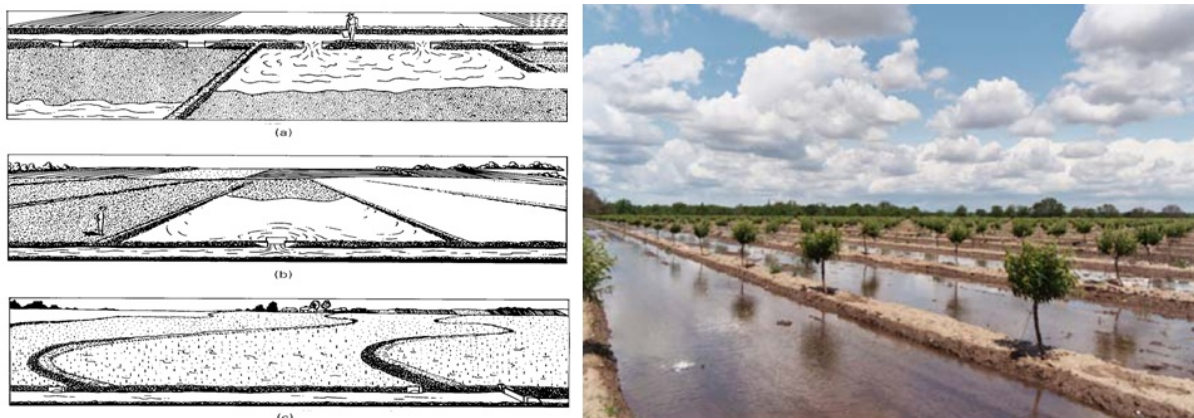
รูปที่ 5 วิธีให้น้ำแบบร่องคูลาด (Graded Furrow Method)
