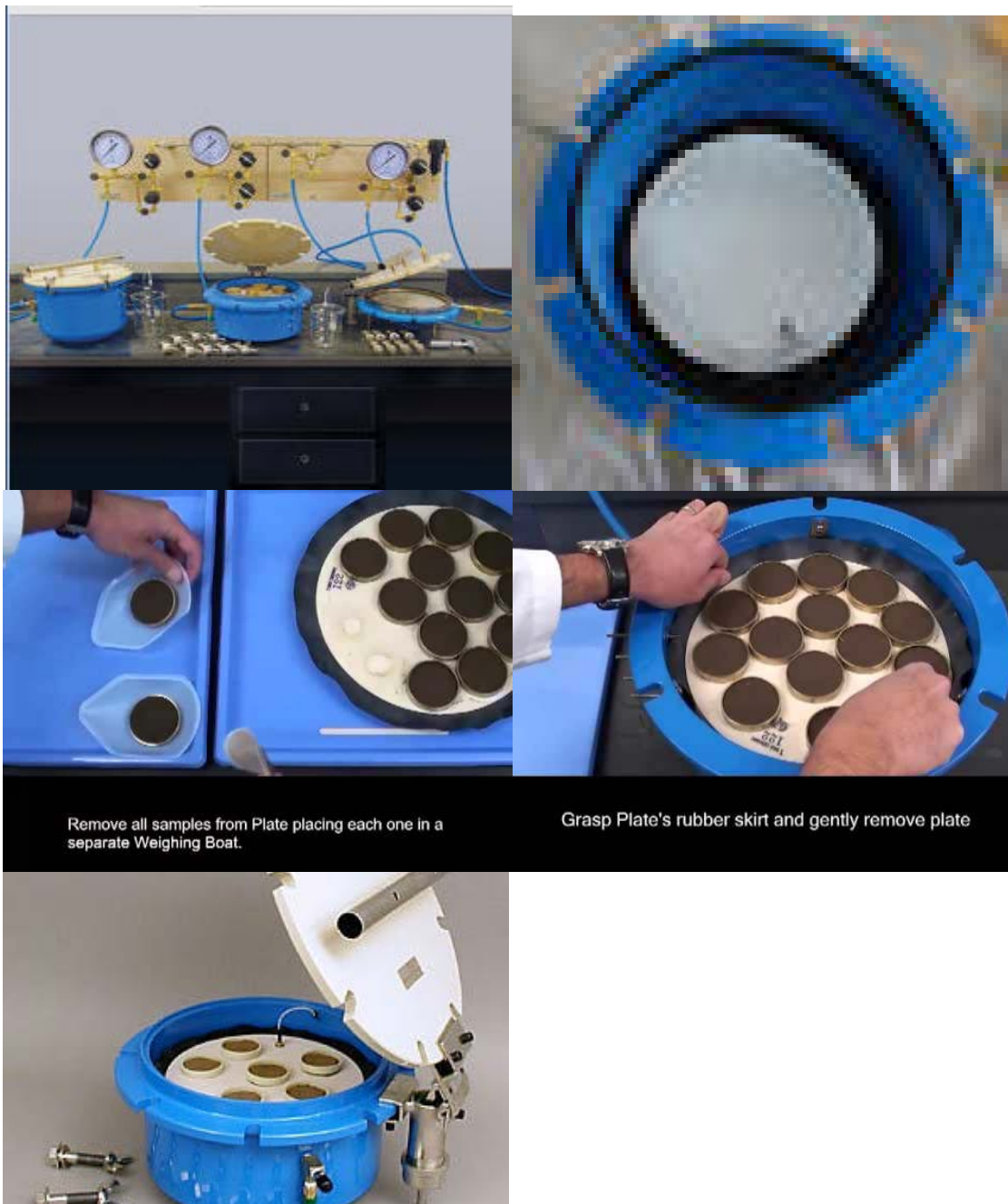
รูปที่ 5 เครื่องแยกความชื้นจากดิน (Soil Moisture Extractor)
