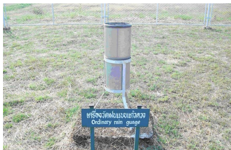
รูปที่ 6.2 เครื่องวัดฝนแบบแก้วตวง (Ordinary Rain Gauge)
