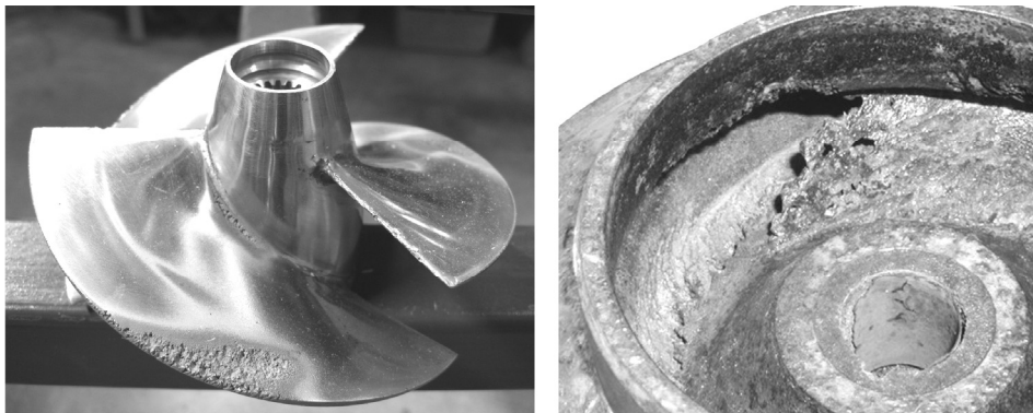
รูปที่ 4.10 การกัดกร่อนที่เกิดขึ้นกับอุปกรณ์เนื่องจาก Cavitations
