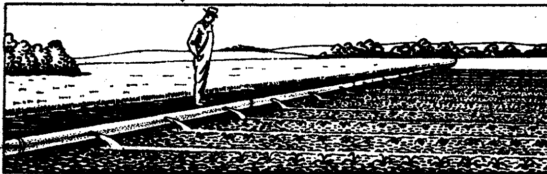
รูปที่ 6.7 การให้น้ำทางร่องคูลาด (GRADED FURROW)
