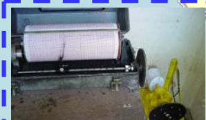
เครื่องบันทึกข้อมูลระดับน้ำลงกราฟ
