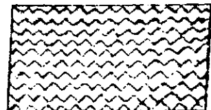
เหล็กปูพื้นกับสัน CHECKERED FLOOR PLATE
