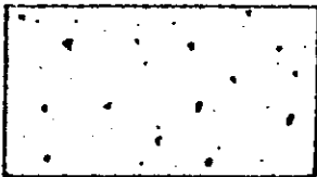
คอนกรีตผสมกรวด GRAVEL CONCRETE
