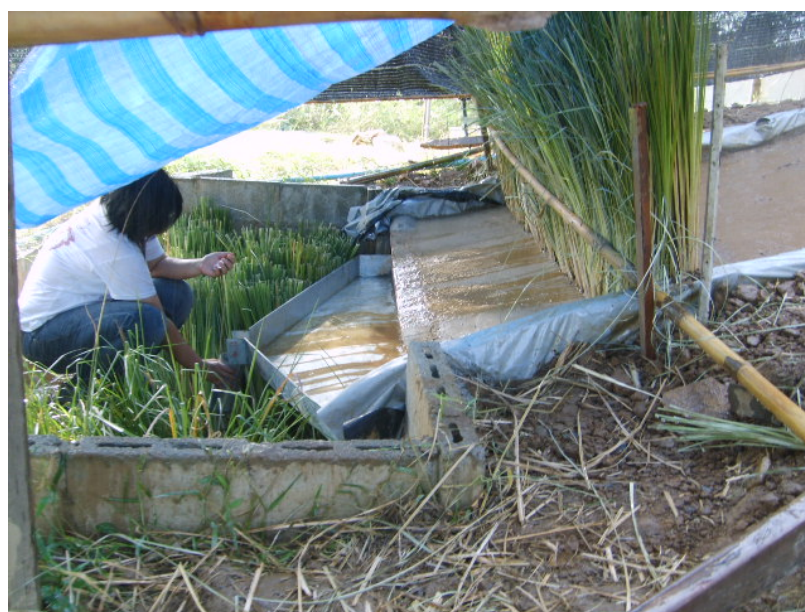
ภาพที่ 3.11 การรับตะกอนดินที่ท้ายแปลง
