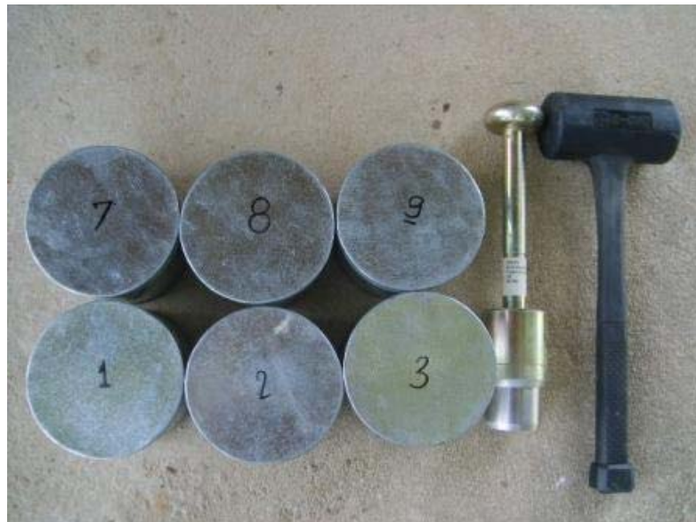
ภาพที่ 3.3 ชุดเก็บตัวอย่างดิน
