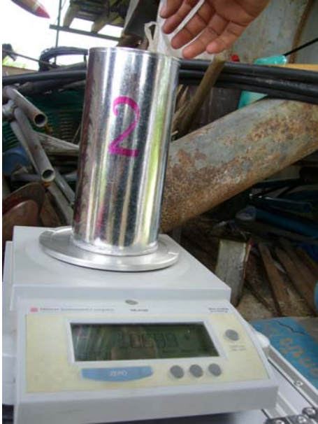
ภาพที่ 3.12 การชั่งน้ำหนักกระป๋องที่มีตะกอนดิน
