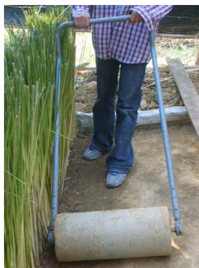
ภาพที่ 3.6 การบดอัดหน้าดินให้มีความหนาแน่นของดินต่างๆกัน
