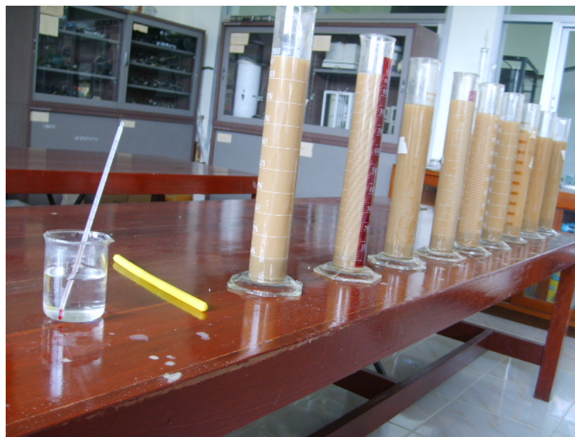
ภาพที่ 3.14 การทำไฮโดรมิเตอร์
