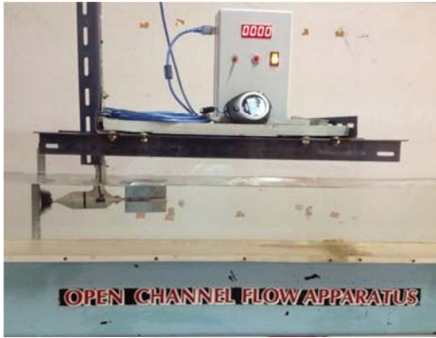
รูปที่ 2 การติดตั้งเครื่องวัดความเร็วกระแสน้ำแบบใบพัดที่ประดิษฐ์
