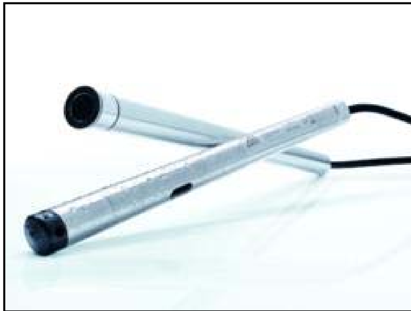
ภาพที่ 9 เครื่องวัดระดับน้ำแบบแรงดัน ยี่ห้อ OTT รุ่น CTD
