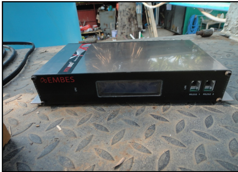
ภาพที่ 10 เครื่อง RTU (Remote Terminal Unit) ยี่ห้อ EMBES รุ่น RTU 800
