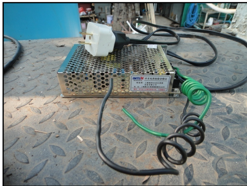
ภาพที่ 11 แหล่งจ่ายไฟตรง (Power Supply) ยี่ห้อ INTAW รุ่น S-50-12
