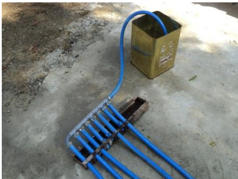
ภาพที่ 24 การนำสายยางที่ต่อกับวาล์วกักเก็บด้านรับน้ำจุ่มลงในแหล่งน้ำจำลอง ทำการทดสอบกับความสูงในระดับต่างๆ (4, 6, 8, 10 และ 12 เมตร) โดยได้ใช้หอสู่ที่ห้องปฏิบัติการทางชลศาสตร์ ซึ่งมีความสูง 12 เมตร เพื่อทำการทดสอบเครื่องปั้มน้ำพลังเหยียบ (ภาพที่ 25)
