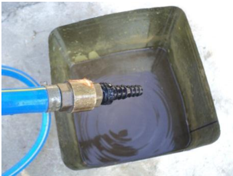
ภาพที่ 22 การต่อวาล์วกันกลับกับสายยางอ่อนด้านรับน้ำ
