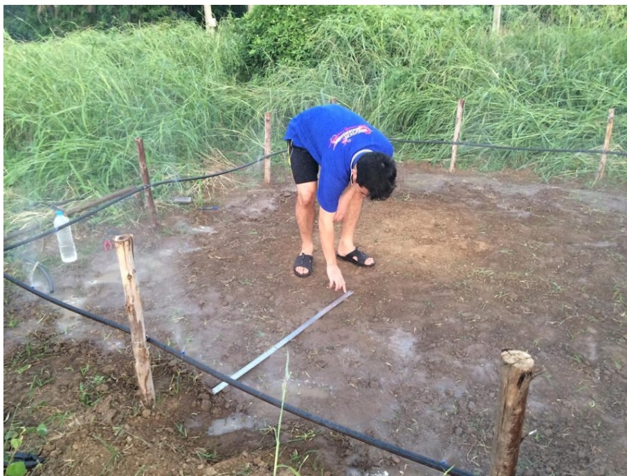
ภาพที่ 6 แสดงการวัดรัศมีและการกระจายตัวของละอองน้ำ
