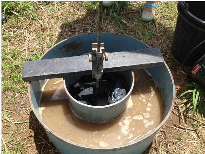
ภาพที่ 3 อุปกรณ์ Double Ring Infiltrometer
