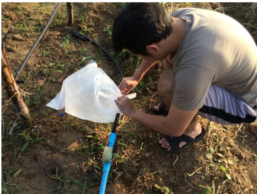
ภาพที่ 9 การใช้ถุงพลาสติกครอบหัวจ่ายน้ำเพื่อหาปริมาณน้ำ
