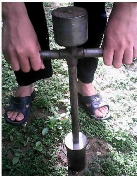
ภาพที่ 3.2 การเก็บตัวอย่างดินโดยใช้ Soil Core Sampler
