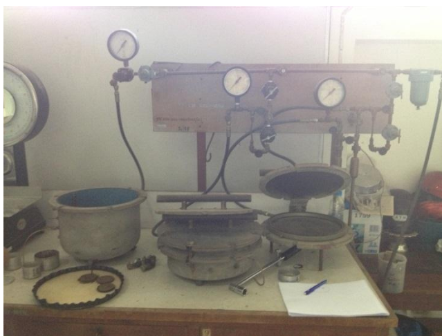
ภาพที่ 3.3 เครื่องแยกความชื้นออกจากดิน (Soil Moisture Extractor)
