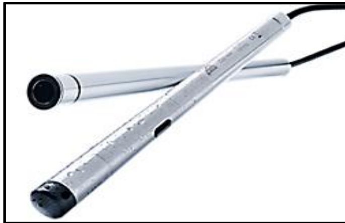
ภาพที่ 17 เครื่องวัดระดับน้ำใต้ดิน ยี่ห้อ OTT รุ่น Orpheus Mini
