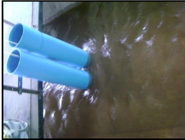
ภาพที่ 78 การทดลองท่อคู่ขนาด 6 นิ้ว
