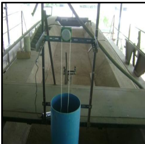
ภาพที่ 75 การตั้งค่าเครื่องวัดแบบลูกลอยโดยการเชื่อมต่อสัญญาณจาก IrDALinkUSB
