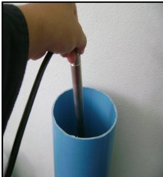
ภาพที่ 87 การติดตั้งเครื่องวัดระดับน้ำแบบใต้ดิน
