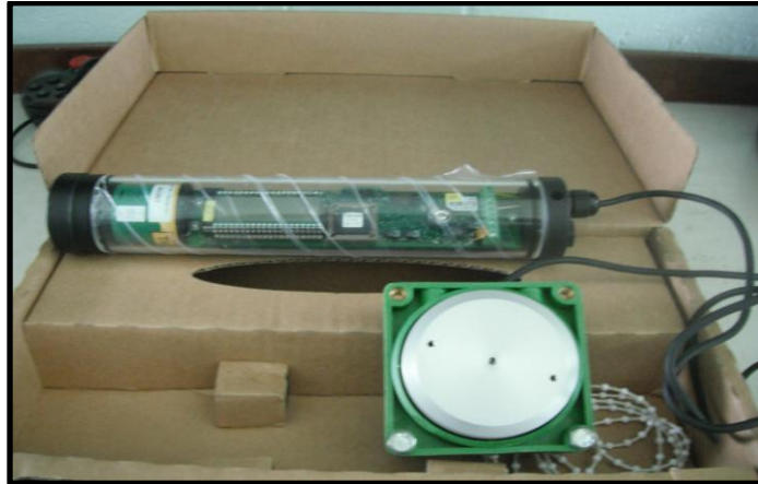
ภาพที่ 16 เครื่องวัดระดับน้ำแบบลูกกลอย ยี่ห้อ OTT รุ่น Thalimedes
