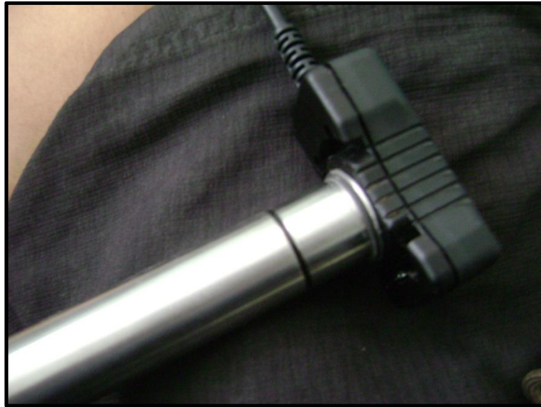
ภาพที่ 88 การเชื่อมต่อ IrDALinkUSB กับหัววัดระดับน้ำแบบใต้ดิน
