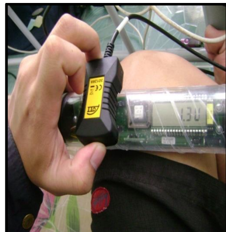
ภาพที่ 75 การตั้งค่าเครื่องวัดแบบลูกลอยโดยการเชื่อมต่อสัญญาณจาก IrDALinkUSB
