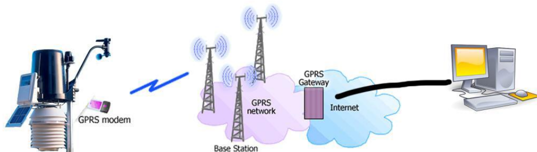
ภาพที่ 5 แสดงลักษณะการทำงานของเครื่องตรวจวัดอากาศในระบบสัญญาณโทรศัพท์
