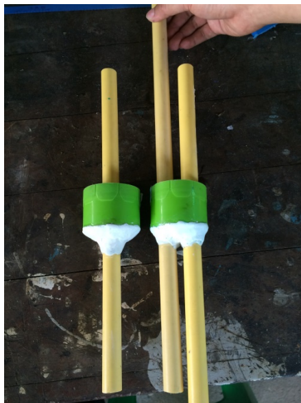
รูปที่ 3.18 รูปแสดงความแตกต่างระหว่างฝาต่อแบบ 1 ท่อและฝาต่อแบบ 2 ท่อ
