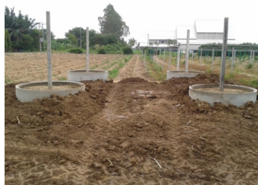
ภาพที่ 10 ภาพแปลนถังวัดการใช้น้ำของพืช ภาพที่ 11 ถังวัดการใช้น้ำของพืชแบบระบายน้ำ
