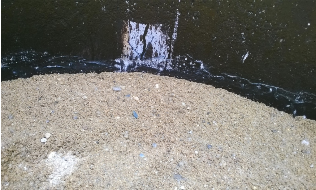
ภาพที่ 32 ใส่น้ำทรายลงในถังวัดการใช้น้ำของพีชหนา 15 เซนติเมตร
