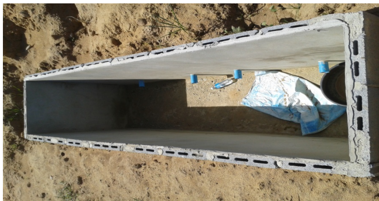
ภาพที่ 13 ห้องตรวจวัดน้ำระบายจากถังวัดการใช้น้ำของพืช
