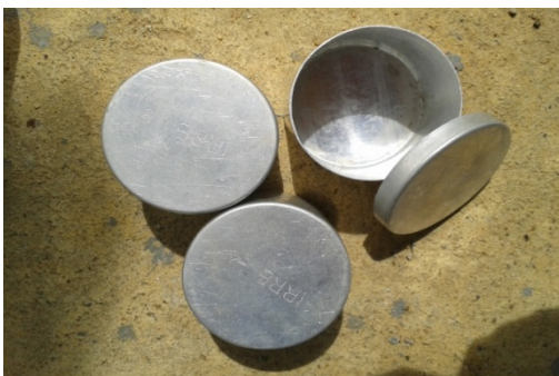
ภาพที่ 19 กระจบองเก็บตัวอย่างดิน จำนวน 1 ชุด
