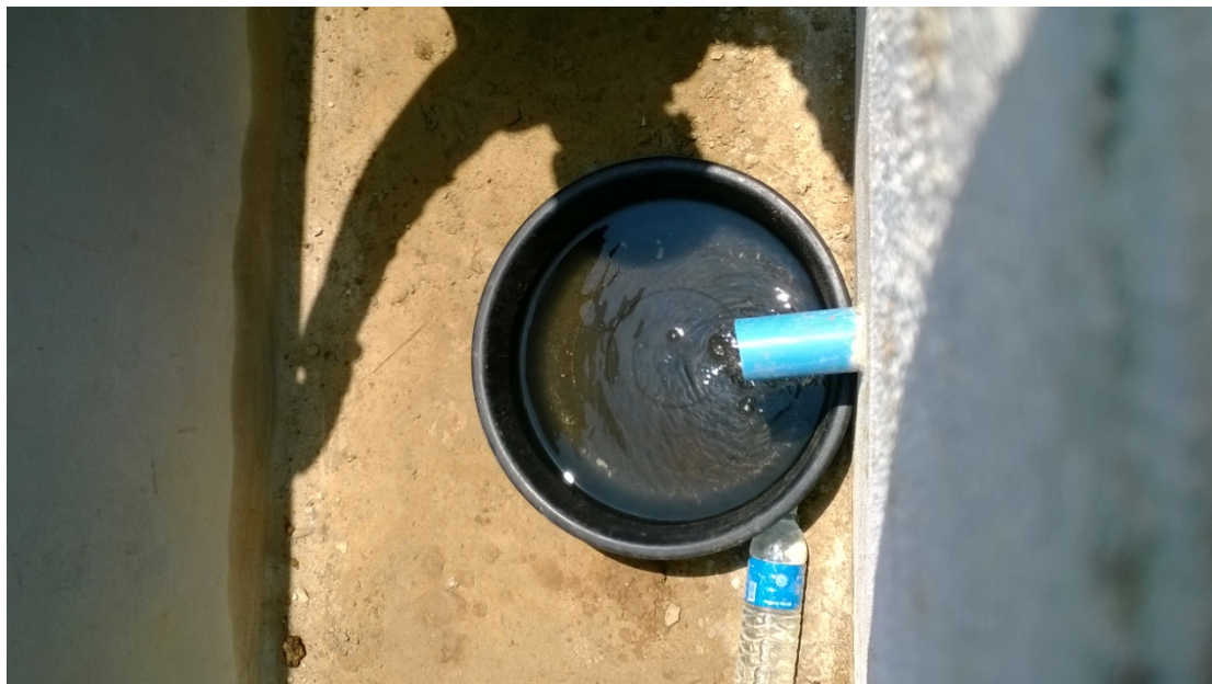
ภาพที่ 38 ตรวจสอบการระบายน้ำของถังวัดการใช้น้ำของพืชแบบระบายน้ำ ทั้ง 4 ถัง
