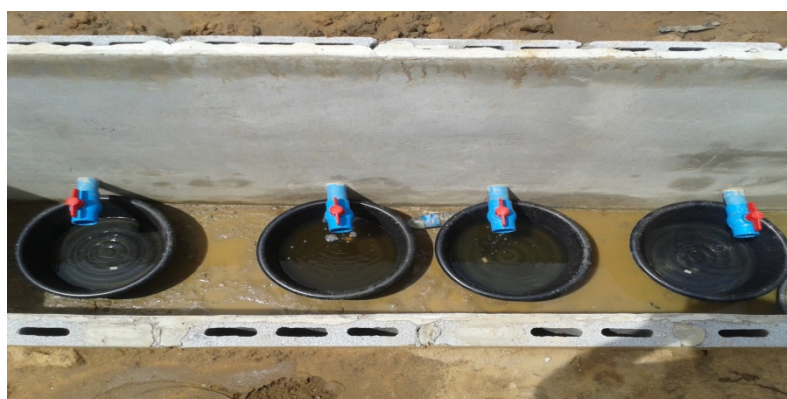
ภาพที่ 14 ถังเก็บน้ำที่ระบายจากถังวัดการใช้น้ำของพืช
