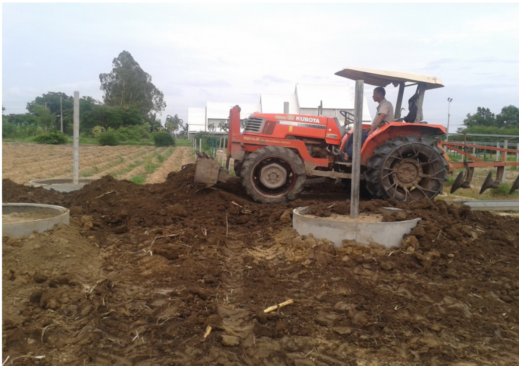
ภาพที่ 35 ถมดินรอบถึงวัดการใช้น้ำของพืช
