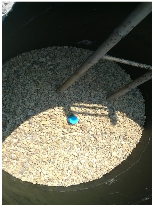
ภาพที่ 31 ใส่หินลงไปกั้นถ่วงวัดการใช้น้ำของพืชหนา 10 เซนติเมตร
