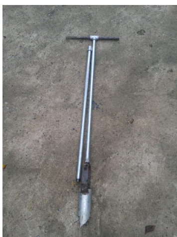
ภาพที่ 4 สว่านขุดเจาะดิน ( Hand Auger )
