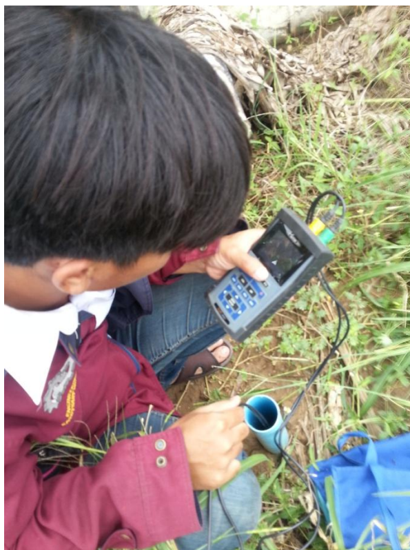
ภาพที่ 17 การวัดคุณภาพน้ำใต้ดินในบ่อตรวจวัดโดยเครื่องมือ WTW multi-3430
