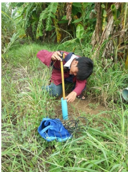
ภาพที่ 21 การวัดความลึกของน้ำใต้ดิน
