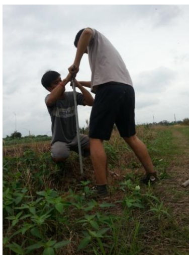
ภาพที่ 14 การขุดดินด้วย Hand Auger
