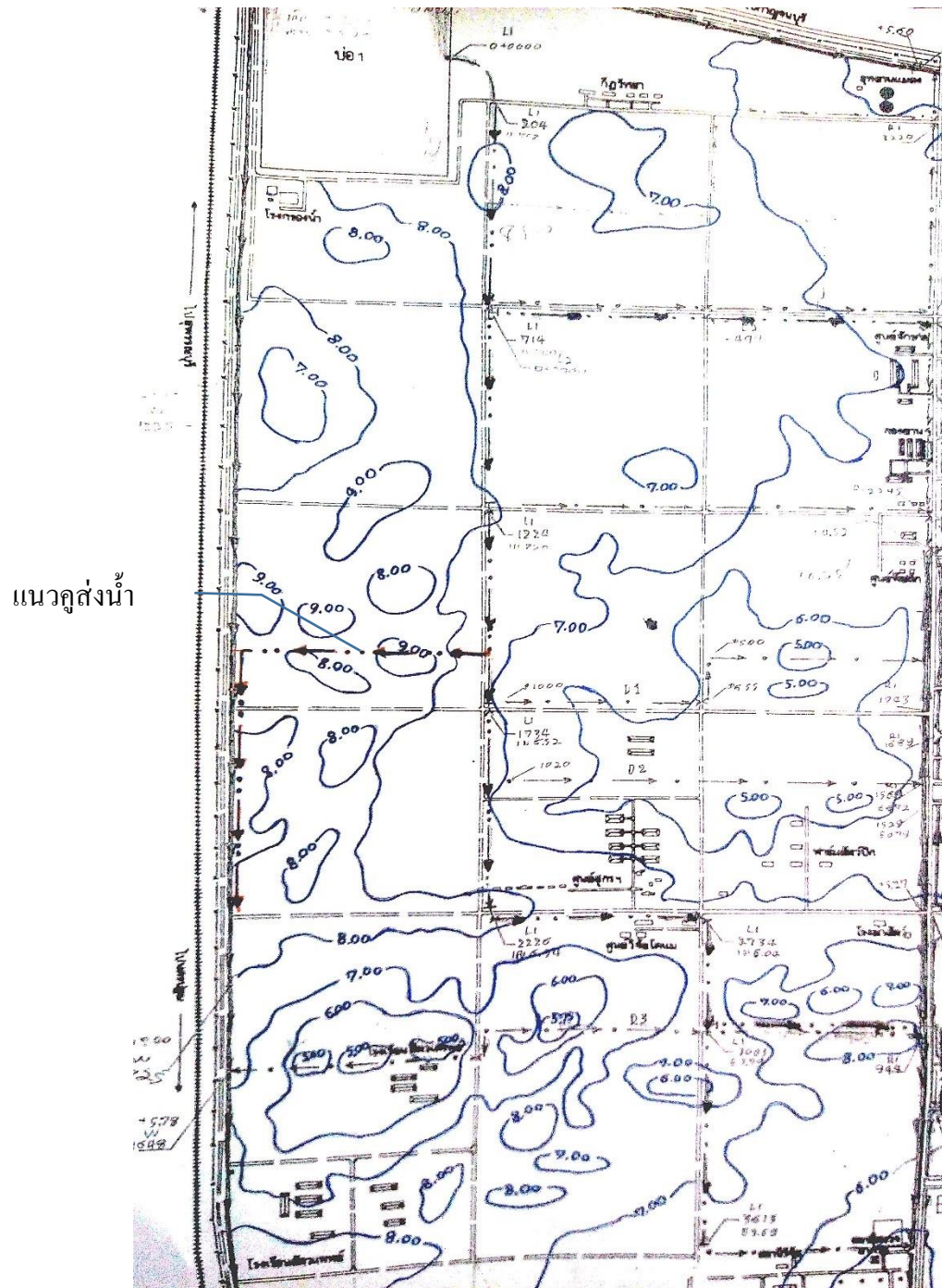
รูปที่ 3.3 แนวคูส่งน้ำเบื้องต้นบนแผนที่เส้นชั้นความสูงของมหาวิทยาลัยเกษตรศาสตร์ วิทยาเขต กำแพงแสน
