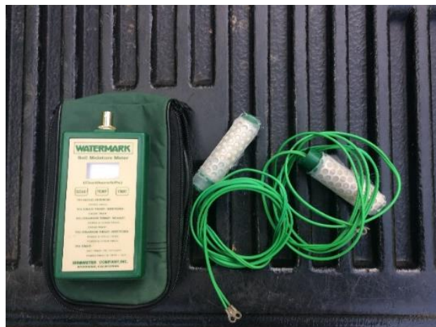
ภาพที่ 3- 6 เครื่องอ่านค่า และ Watermark Soil Moisture Sensor
