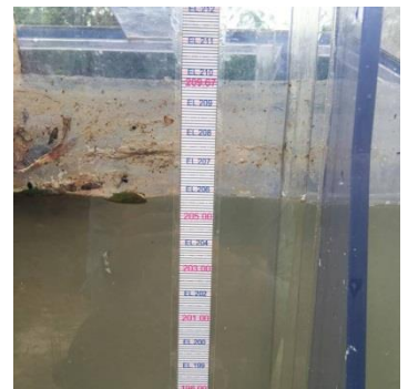
รูปที่ 4(b) น้ำจะไหลเข้าสู่อาคารรับน้ำทางเข้าอุโมงค์ที่มีประตูควบคุมการปิด-เปิด ซึ่งจะมีगेจวัดระดับน้ำติดตั้งอยู่ที่ บริเวณด้านเหนือน้ำและด้านท้ายน้ำ
