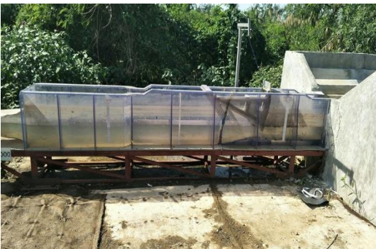
รูปที่ 4(b) น้ำจะไหลเข้าสู่อาคารรับน้ำทางเข้าอุโมงค์ที่มีประตูควบคุมการปิด-เปิด ซึ่งจะมีगेจวัดระดับน้ำติดตั้งอยู่ที่ บริเวณด้านเหนือน้ำและด้านท้ายน้ำ
