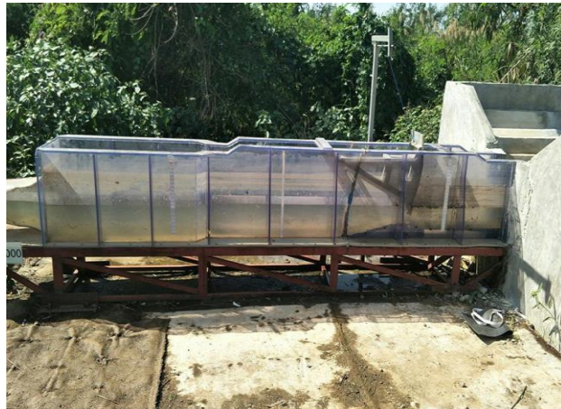
รูปที่ 3(b) อาคารทางเข้าอุโมงค์ที่มีประตูควบคุมการปิด-เปิด รวมความยาว 4.40 เมตร
