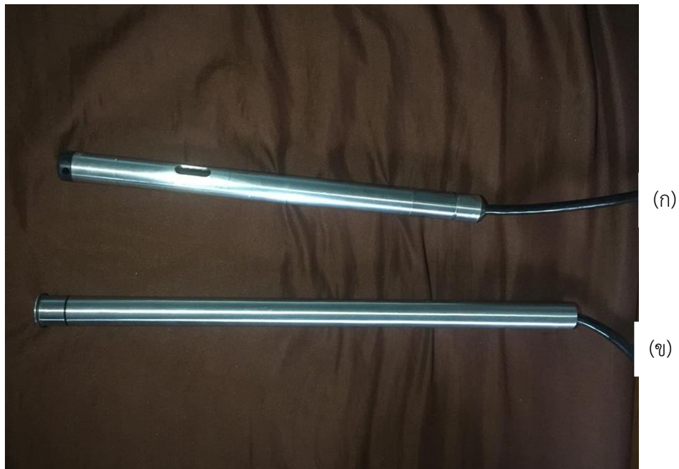
ภาพที่ 10 เครื่องวัดระดับน้ำแบบแรงดัน ยี่ห้อ OTT รุ่น CTD (ก) ส่วนที่นำลงน้ำ โดยให้ปลายสัมผัสกับพื้น (ข) เชื่อมต่อกับ IrDA Link USB
