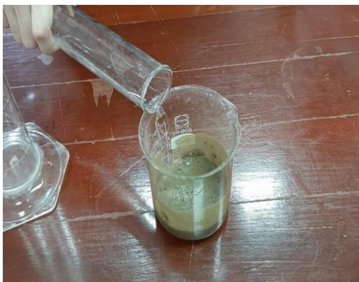
ภาพที่ ข-2 เติมสารละลายแคลกอน 5% 100 ml
