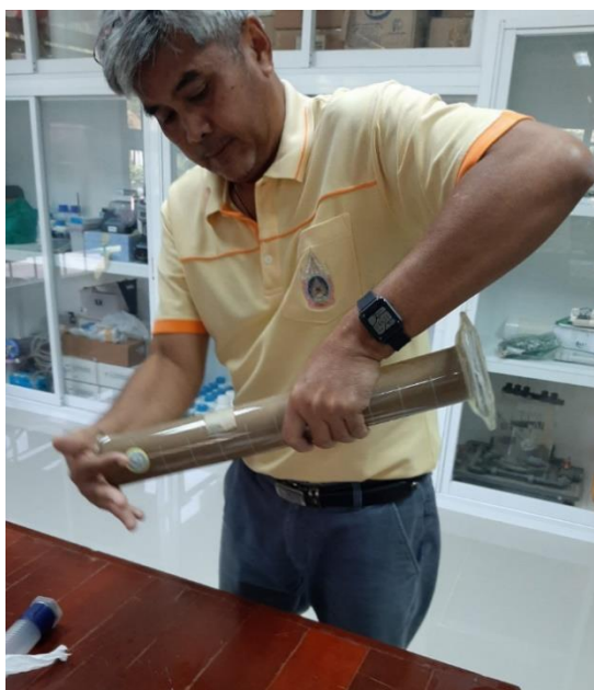
ภาพที่ ข-6 เขย่ากระบอกตวงเพื่อทำให้เกิดสารแขวนลอยดินที่สมบูรณ์สักกระยะหนึ่ง
