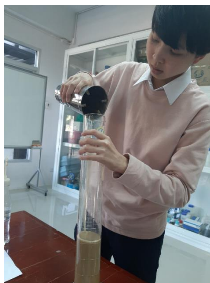
ภาพที่ ข-5 ถ่ายสิ่งที่ปั่นลงในกระบอกแก้ว ใช้น้ำกลั่นฉีดล้างดินที่ ลงในกระบอกแก้วให้หมด
