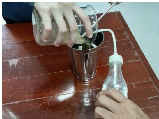
ภาพที่ ข-3 เติมน้ำกลั่นลงใน dispersion cup
