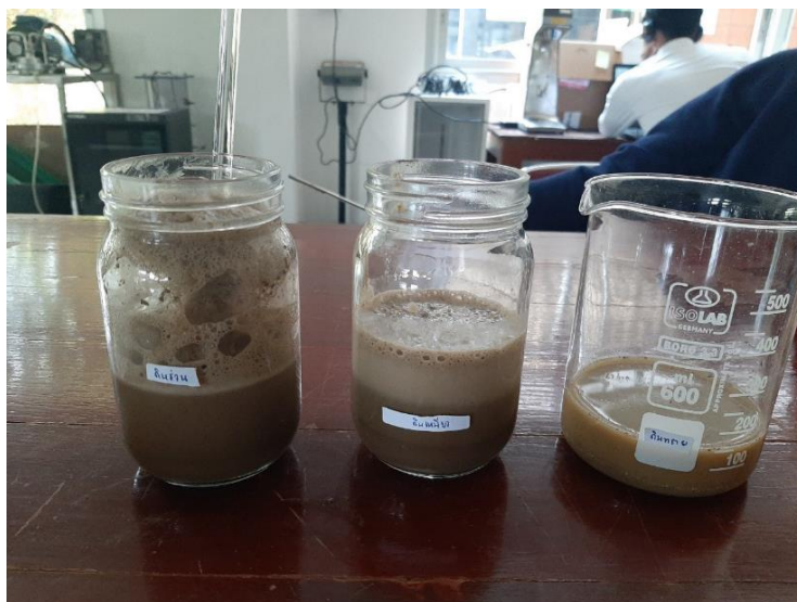
ภาพที่ ข-1 กำจัดอินทรีย์วัตถุ โดยไฮโดรเจนเปอร์ออกไซด์
