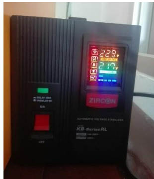
รูปที่ 11 รอจนกว่า Stabilizer:ZIRCON:KB-1000RL จะขึ้นค่าพลังงานของไฟฟ้า
