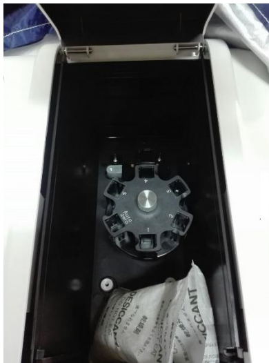
รูปที่ 2 6-Position Cell Holder Automatic สำหรับ Cell ขนาด 10 mm.
