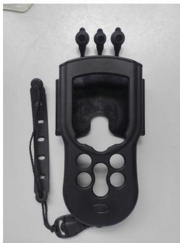
รูปที่ 3 แสดงปลอกป้องกันสำหรับมิเตอร์ HQd
