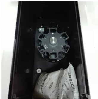
รูปที่ 52 แสดงการนำถุงกันชื้นใส่ในช่องใส่ Cuvette
