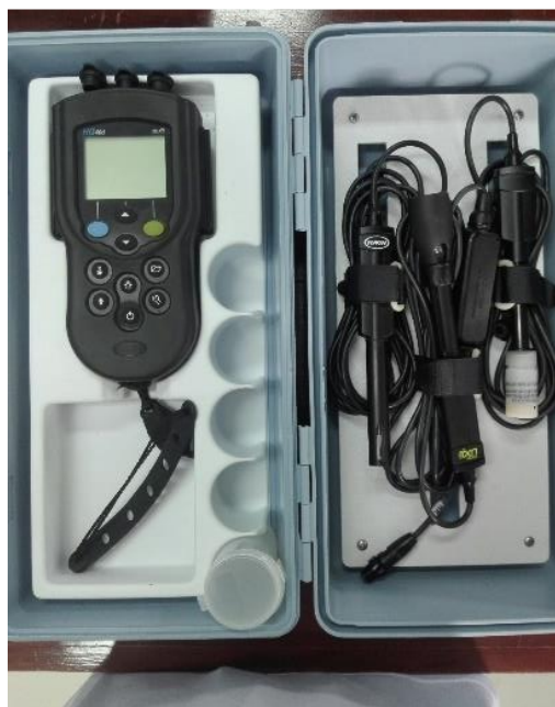
รูปที่ 4.5 แสดงการจัดเก็บเครื่องตรวจวัดคุณภาพน้ำ
