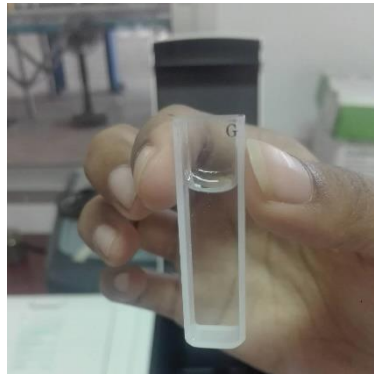
รูปที่ 15 แสดงการเติมน้ำที่ต้องการทดสอบ 3 ส่วน 4 ของ Cuvette
