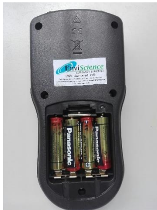
รูปที่ 2 แสดงช่องใส่อัลคาไลน์แบตเตอรี่ขนาด AA จำนวน 4 ก้อน
