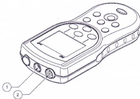
รูปที่ 8 แสดงตัวเครื่องและตำแหน่งการเชื่อมต่อหัววัด
