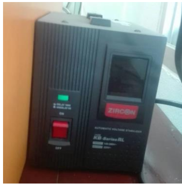
รูปที่ 10 กดเปิดสวิตซ์ไฟที่ Stabilizer:ZIRCON:KB-1000RL
