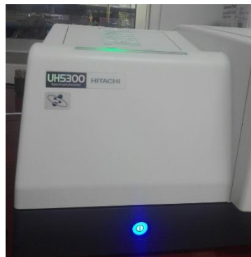
รูปที่ 13 เปิดเครื่อง Spectrophotometer และทำการรอจนกว่าไฟสีเขียวจะดับลง
