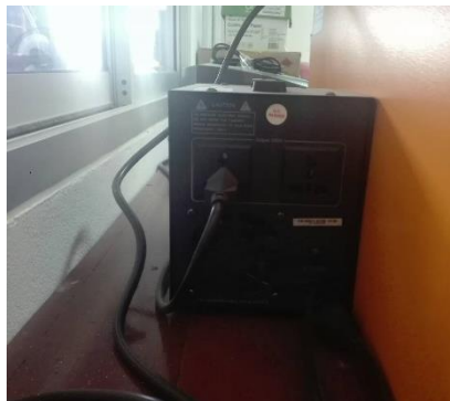
รูปที่ 8 แสดงสายจากเครื่อง Spectrophotometer เชื่อมต่อกับ Stabilizer:ZIRCON:KB-1000RL
