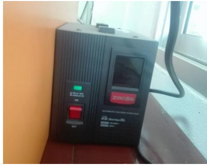
รูปที่ 54 แสดงการกดปิดสวิตซ์ไฟที่ Stabilizer:ZIRCON:KB-1000RL
