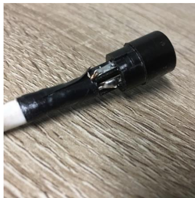
รูปที่ 3-40 ลักษณะของ Connector ตัวเมีย รูปที่ 3-41 ลักษณะรอยเชื่อมต่อของ Connector ตัวเมีย
