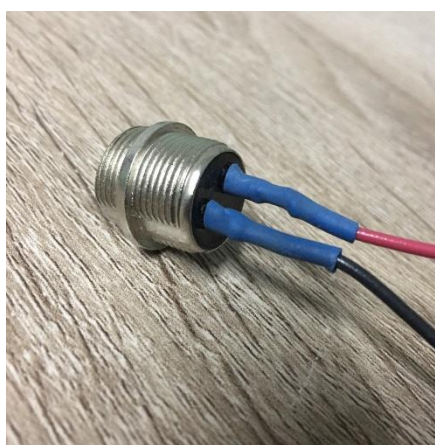
รูปที่ 3-43 ลักษณะรอยเชื่อมต่อของ Connector ตัวผู้
