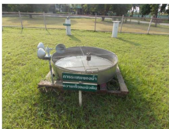
รูปที่ 2-7 ภาตวัดการระเหย American Class A Pan
