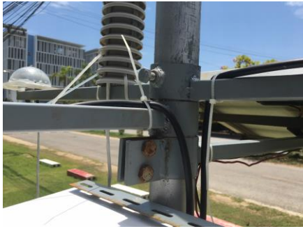
รูปที่ 3-35 การทำแกนสำหรับใช้วางอุปกรณ์ ตรวจวัดค่า
