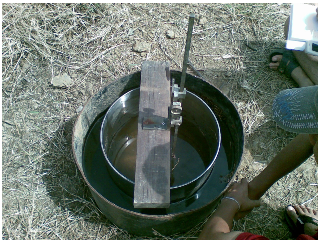
ภาพที่ 9 ถังวัดอัตราการซึมของน้ำผ่านผิวดินแบบวงแหวนสองชั้น
