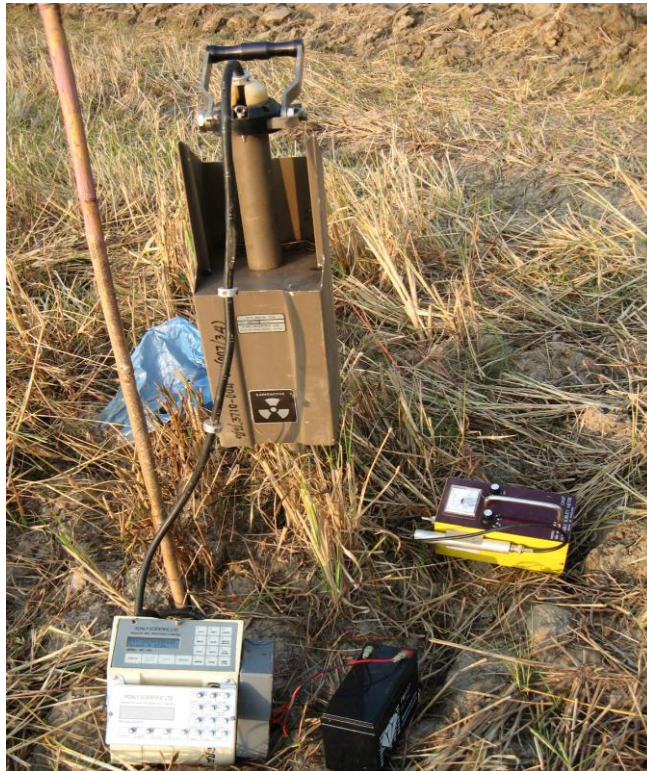
ภาพที่ 9 เครื่องวัดความชื้นในดินแบบนิวตรอน
