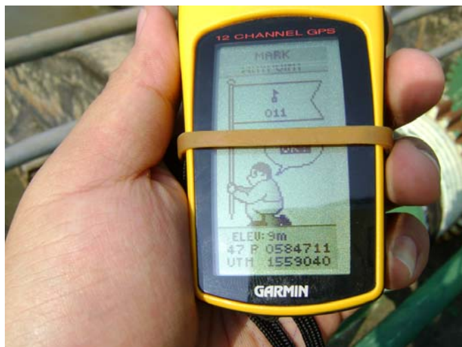
ภาพที่ 10 การเก็บข้อมูลตำแหน่งพิกัดของอาคารชลประทานด้วย GPS
