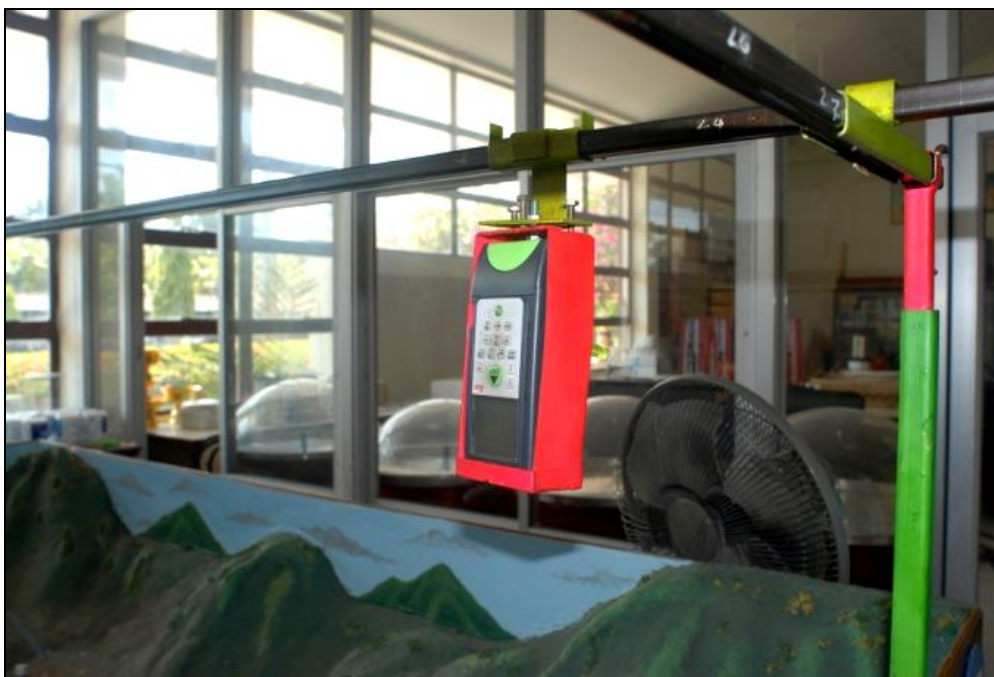
ภาพที่ 3.2 โครงสร้างที่ใช้ยึดเครื่องวัดระยะเลเซอร์
