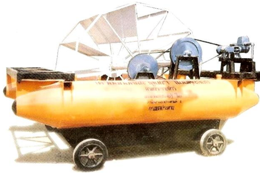
ภาพที่ 2.13 กังหันน้ำสูบน้ำแบบทุ่นลอยตั้งอยู่บนบก ที่มา :บรรจง ,2542
