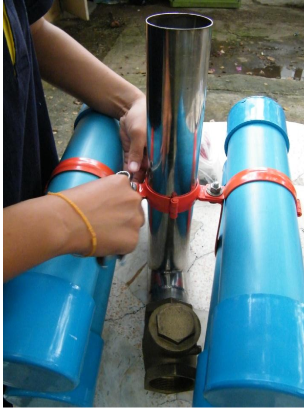
ภาพผนวกที่ ง.2.3 การประกอบตัวเครื่องสูบน้ำกับตัวหุ่นลอยเข้าด้วยกัน
