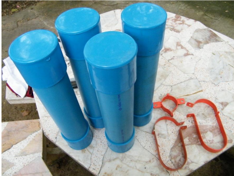
ภาพผนวกที่ ง.2.1 ท่อ PVC ที่ตามขนาดที่วัดไว้เพื่อนำมาใช้เป็นท่อนลอย
