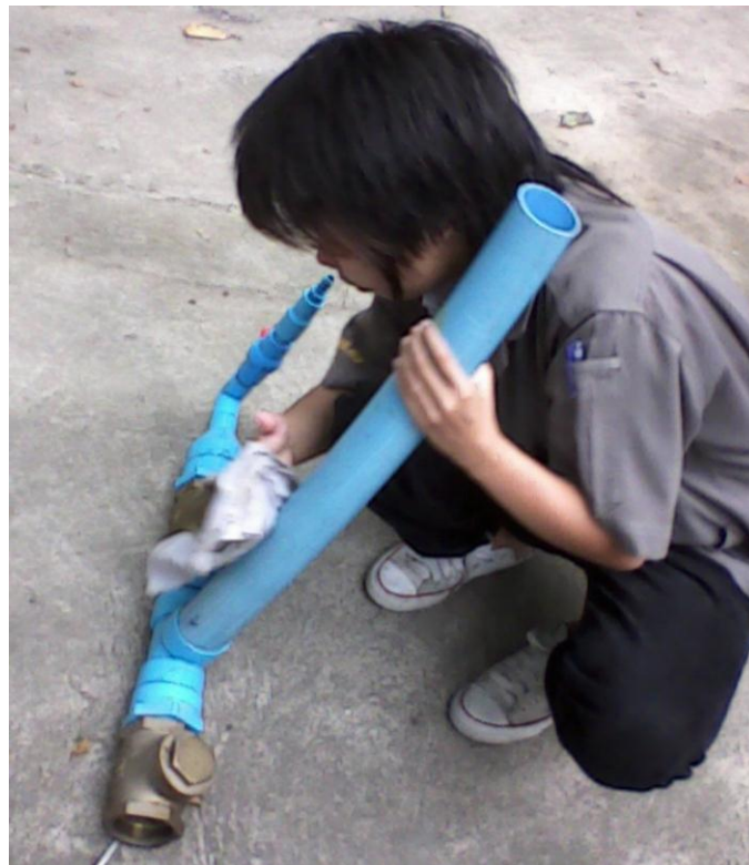
ภาพผนวกที่ ง.1.4 หลังการประกอบตัวเครื่องสูบน้ำพลังงานคลื่น
