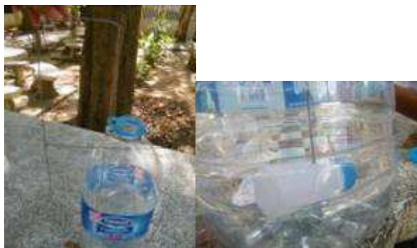
ภาพผนวกที่ 15 ใส่ลวดที่ตัดไว้ในข้อแรกในขวดยาที่เจาะไว้
