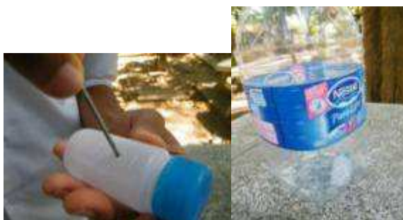
ภาพผนวกที่ 12 เจาะรูที่ขวดยาเพื่อทำเป็นลูกลอย
