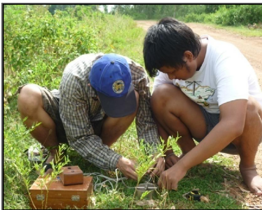
ภาพที่ 26 การติดตั้งเครื่องวัดความเร็วของกระแสน้ำ แบบ Propeller
