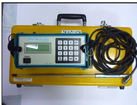
ภาพที่ 16 เครื่องมือวัด Electromagnetic Current Meter
