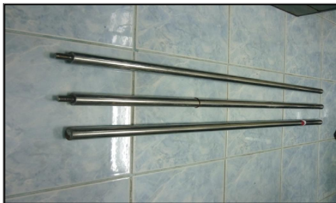
ภาพที่ 20 ก้านหยั่ง (Wading Rod) ขนาดเส้นผ่านศูนย์กลาง 1 นิ้ว ยาวท่อนละ 1 เมตร
