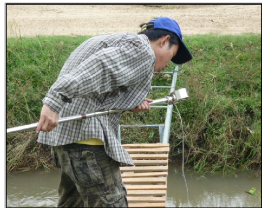
ภาพที่ 26 การติดตั้งเครื่องวัดความเร็วของกระแสน้ำ แบบ Propeller
