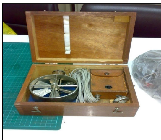
ภาพที่ 19 เครื่องมือ Electric Current Meter (Propeller)
