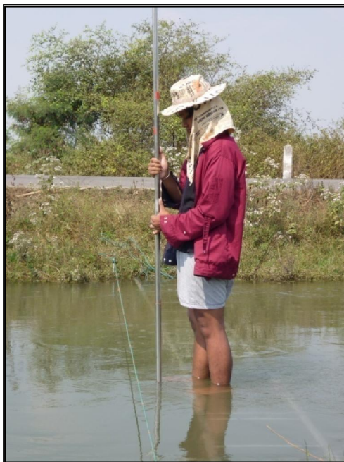
ภาพที่ 27 ลักษณะการวัดความเร็วกระแสน้ำ
