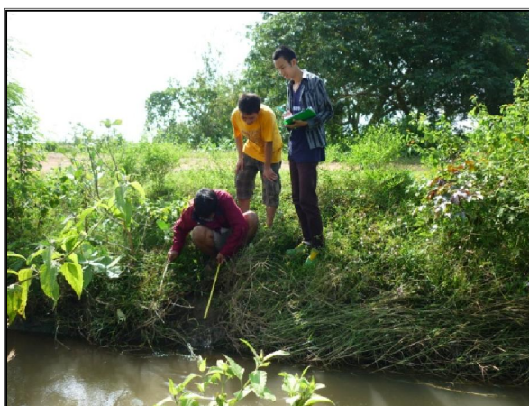
ภาพที่ 24 การวัดระดับด้านเหนือน้ำและท้ายน้ำ
