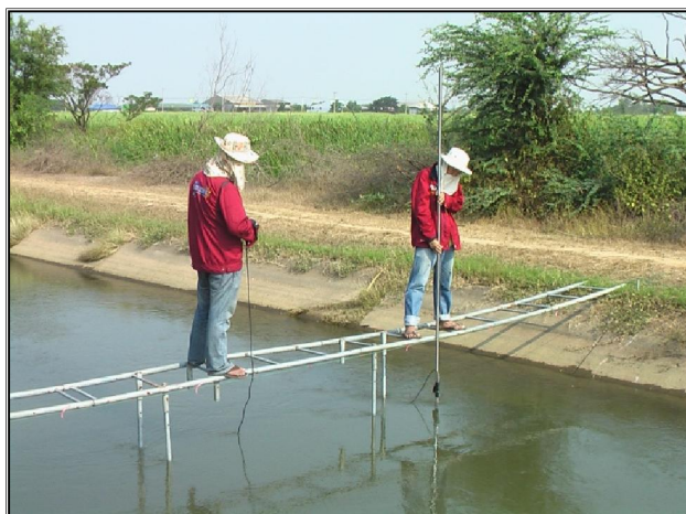
ภาพที่ 28 การวัดความเร็วของกระแสน้ำโดยเครื่องมือ Electromagnetic Current Meter
