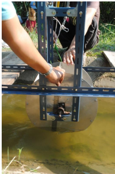
รูปที่ 3.7 การปรับระดับการจมของกักน้ำ
