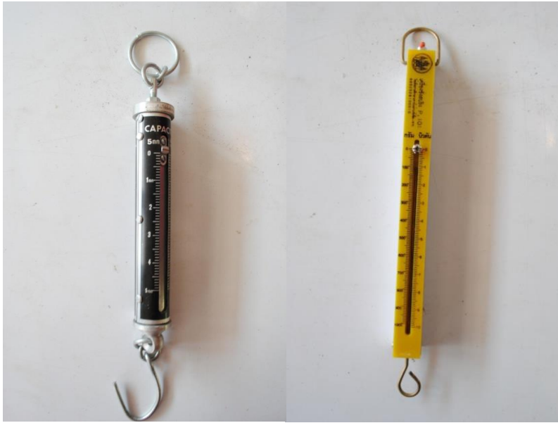
รูปที่ 3.4 ตาชั่งสปริงขนาด 5 kg และ 1 kg
