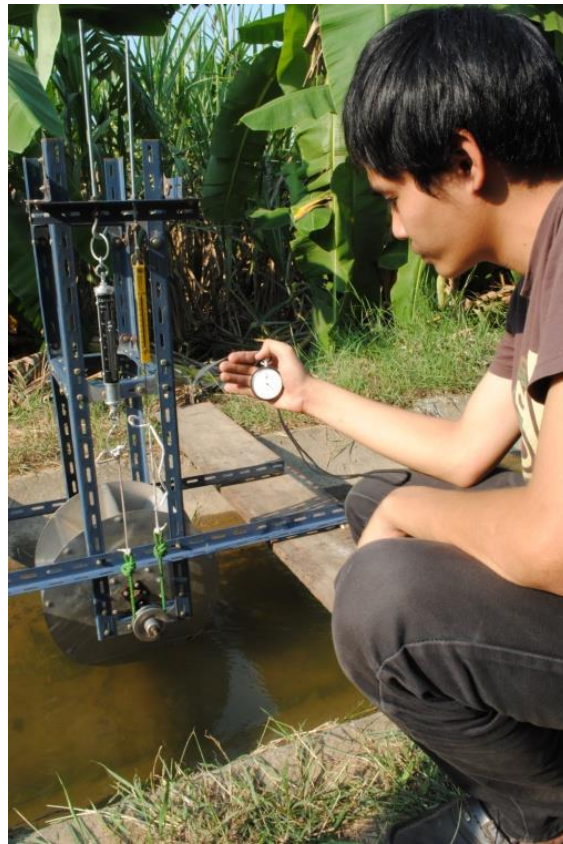
รูปที่ 3.10 การจับเวลาที่กังหันหมุนครบ 10 รอบ
