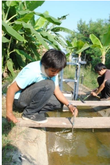
รูปที่ 3.8 การวัดความเร็วของกระแสน้ำด้านเหนือน้ำ
