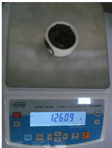
ภาพที่ 9 การนำตัวอย่างดินใส่ในถ้วยกระเบื้องบนเครื่องชั่งน้ำหนัก
