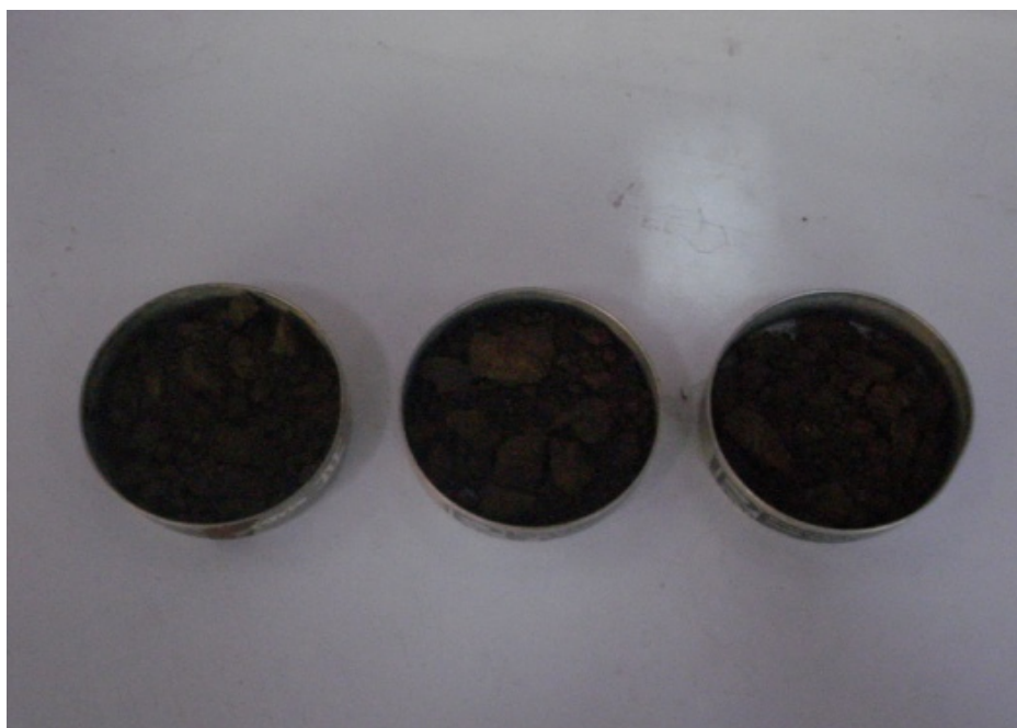
ภาพที่ 8 ตัวอย่างดินเมื่อบรรจุในกระป๋องเก็บตัวอย่างดิน
