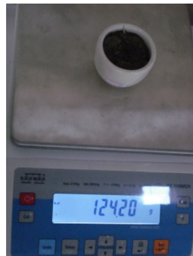
ภาพที่ 9 การนำตัวอย่างดินใส่ในถ้วยกระเบื้องบนเครื่องชั่งน้ำหนัก
