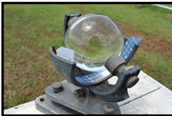
ภาพที่ 8 เครื่องวัดแสงแดดแบบแคมป์เบลสโตกส์ ที่มา: สถานีอุตุนิยมวิทยา จ.นครปฐม
