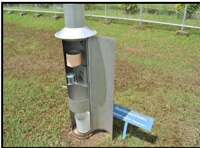
ภาพที่ 12 เครื่องวัดฝนแบบไซฟอน ที่มา: สถาบันอุตุนิยมวิทยา จ.นครปฐม
