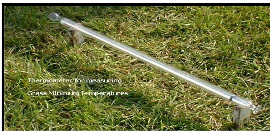
ภาพที่ 6 เทอร์โมมิเตอร์ต่ำสุดยอดหญ้า
