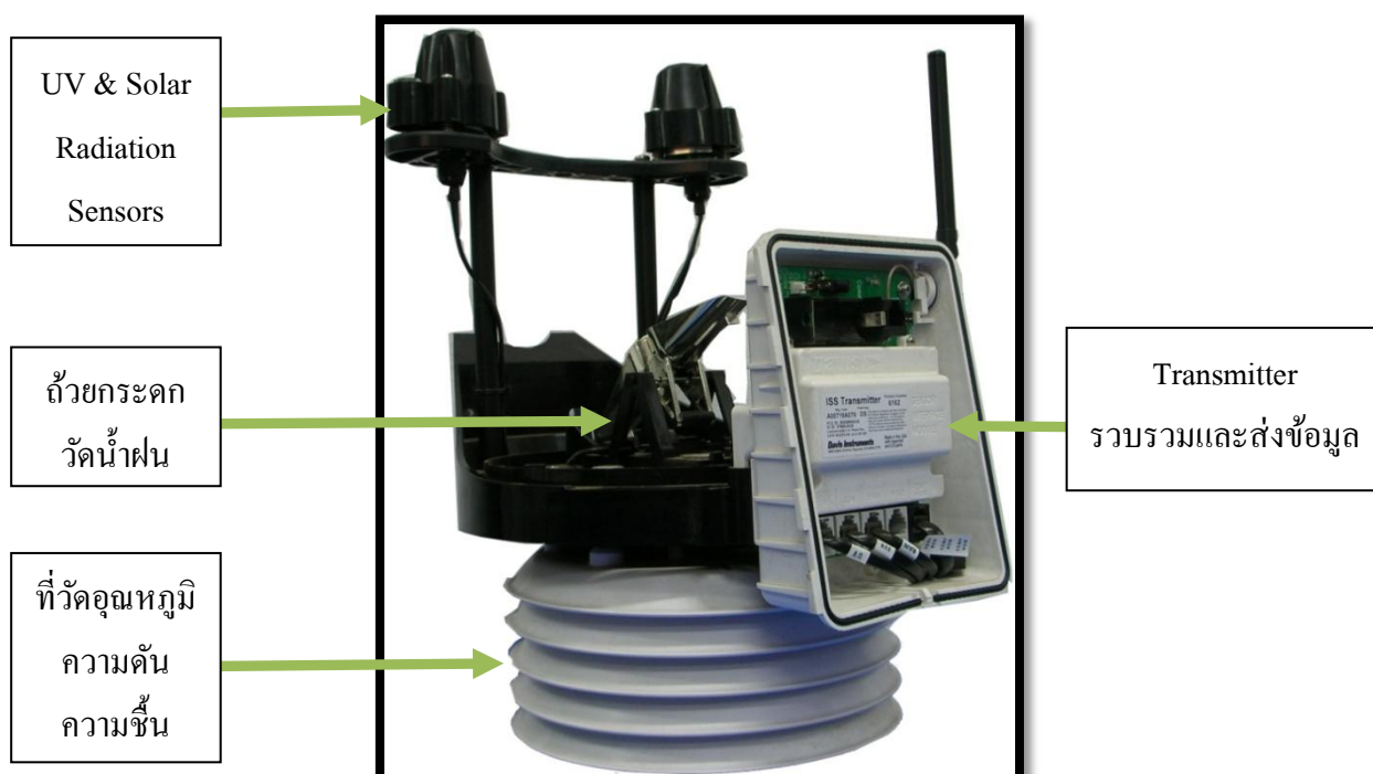
ภาพที่ 20 Wireless Vantage Pro Plus including UV & Solar Radiation Sensors
