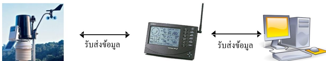
ภาพที่ 18: แสดงลักษณะการทำงานของเครื่องตรวจวัดอากาศในระบบสัญญาณวิทยุ
