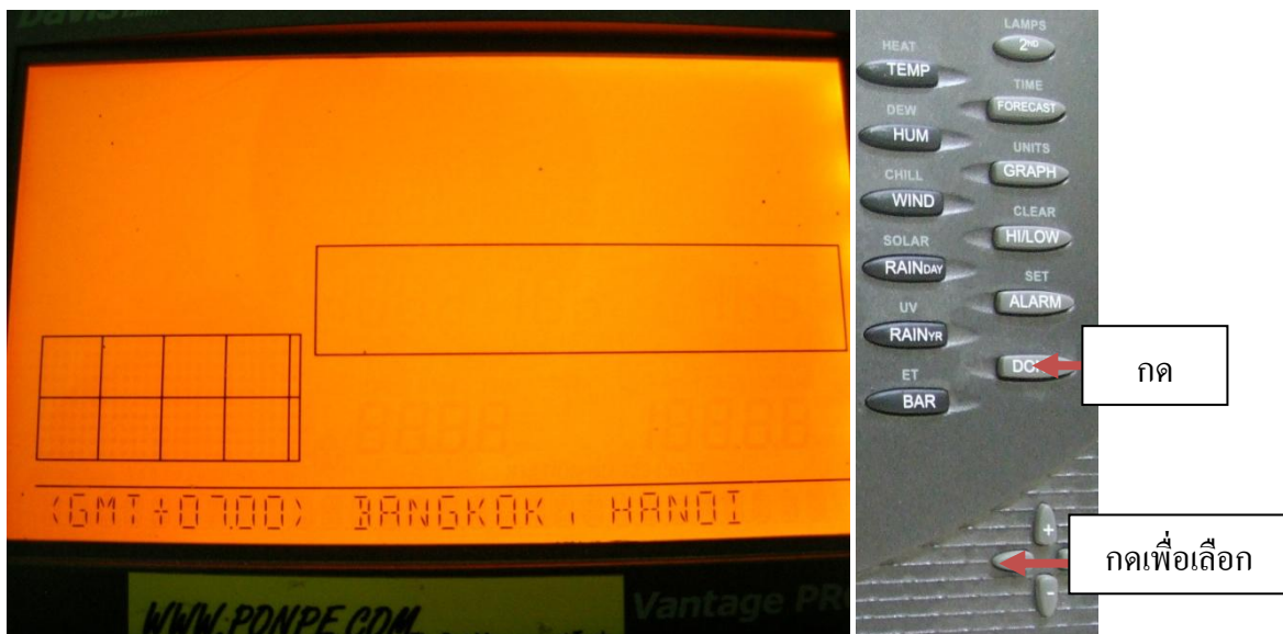
ภาพที่ 43 การตั้งเขตเวลาเครื่องรับสัญญาณ Weather Link for Vantage Pro Plus
