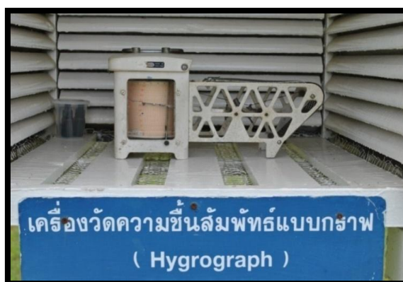
ภาพที่ 7 เครื่องวัดความชื้นสัมพัทธ์แบบกราฟ ที่มา: สถาบันอุตุนิยมหาวิทยาลัย จ.นครปฐม
