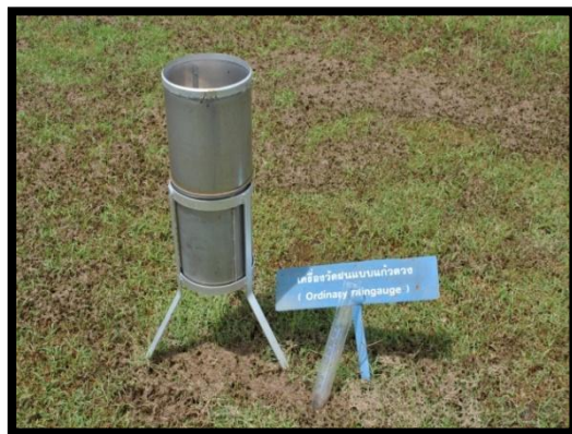
ภาพที่ 13 เครื่องวัดฝนแบบแก้วดวง ที่มา: สถานีอุตุนิยมวิทยา จ.นครปฐม
