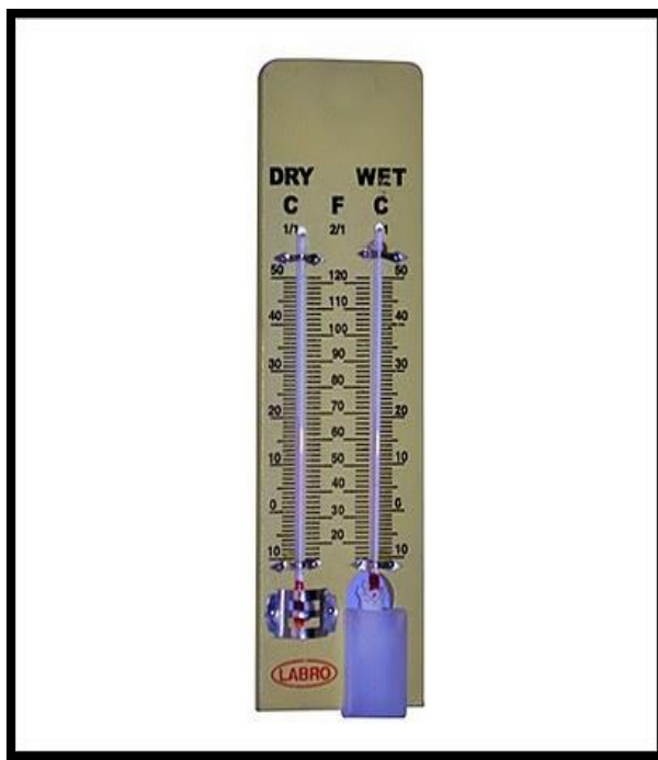
ภาพที่ 4 เทอร์โมมิเตอร์อุณหภูมิกระเปาะแห้ง และอุณหภูมิกระเปาะเปียก ที่มา: www.homepage.ntlworld.com
