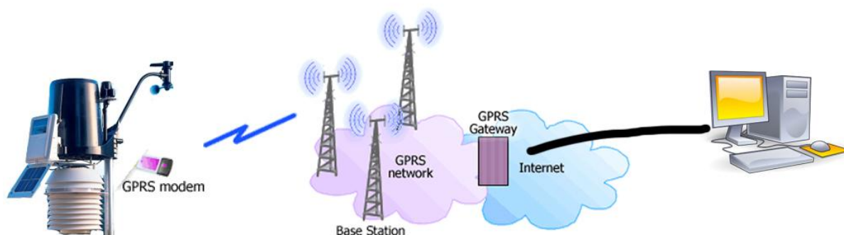
ภาพที่ 19: แสดงลักษณะการทำงานของเครื่องตรวจวัดอากาศในระบบสัญญาณโทรศัพท์
