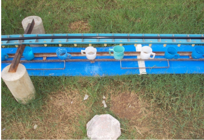
ภาพที่ 3.1 รางน้ำสำหรับวัดปริมาณน้ำที่ออกมาจากสายน้ำหยด เป็นท่อ PVC ฝาครึ่ง โดยเจาะรูเป็นช่วง ช่วงละ 10 เซนติเมตร ส่วนด้านใต้เป็นแก้วน้ำและถาดสำหรับวางแก้วน้ำ
