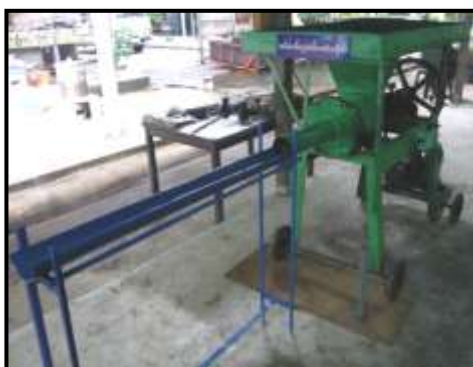
รูปที่ 4 เครื่องขึ้นรูปเชื้อเพลิงเขียว และฐานรองรับสำหรับการอัดแท่งวัสดุปลูก
