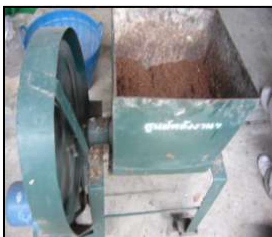
เครื่องผสมวัสดุปลูกก่อนการอัดแท่ง
