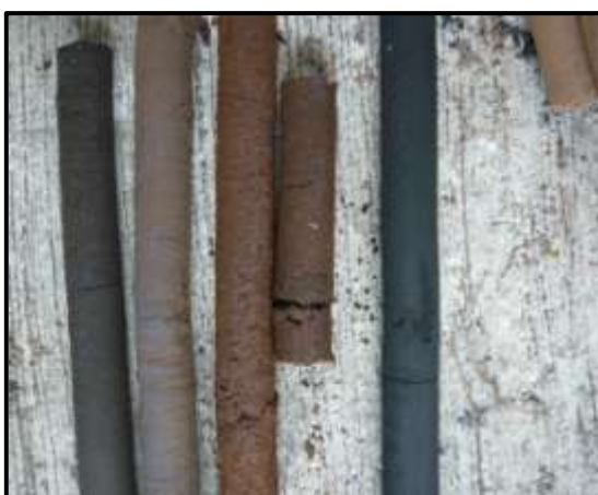
รูปที่ 15 วัสดุปลุกอัดแท่ง นำออกมาวางตากแดด โดยวัสดุบางชนิดเกิดรอยแตกตั้งแต่ความยาว 40 เซนติเมตร ขึ้นไป ดังนั้นการทดสอบวัสดุจึงใช้ขนาดความยาวของวัสดุไม่เกิน 40 เซนติเมตร
