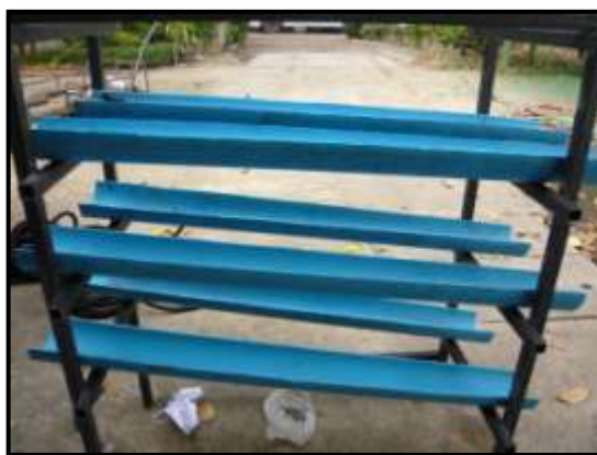
รูปที่ 22 โครงเหล็ก กับท่อ PVC ประกอบกันเป็นชุดอุปกรณ์การให้น้ำสำหรับสวนแนวตั้ง
