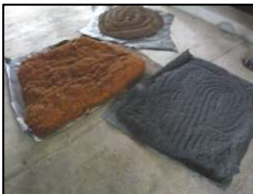
รูปที่ 9 วัสดุปลูกที่จะนำไปอัดแท่ง (ซีเมนต์กลบ ขุยมะพร้าว และซีลี้อย)
