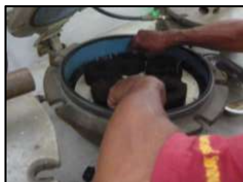
รูปที่18 การวาง pressure plate ใน pressure chamber
