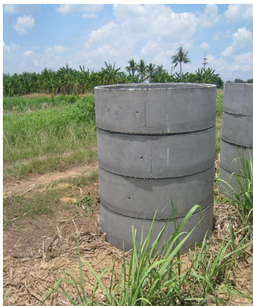
ภาพที่ 12 ร่องคอนกรีต ขนาด 1.2 m.
