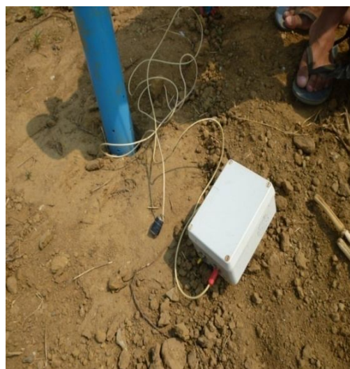
ภาพที่ 9 เครื่องวัดระดับน้ำชนิดแบบเสียงเตือน
