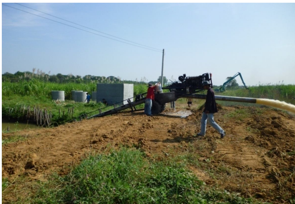
ภาพที่ 19 การสูบน้ำออกจากแปลงทดลองด้วยเครื่องสูบน้ำขนาดใหญ่
