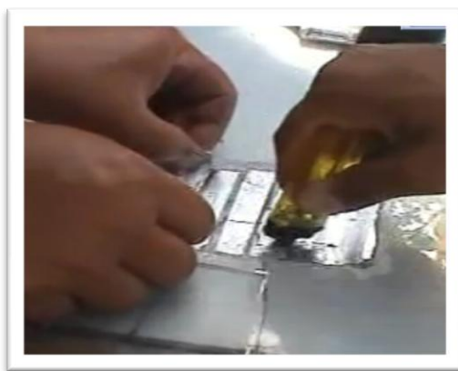
รูปที่ 3.13 แสดงการใช้ลูกกลิ้งไฟแช็ก กลิ้งไปบนแผ่นอลูมิเนียมฟรอยด์
