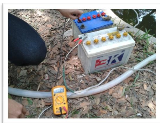
รูปที่ 3.22 แสดงการวัดค่าแรงดันไฟฟ้า และค่ากระแสไฟฟ้า
