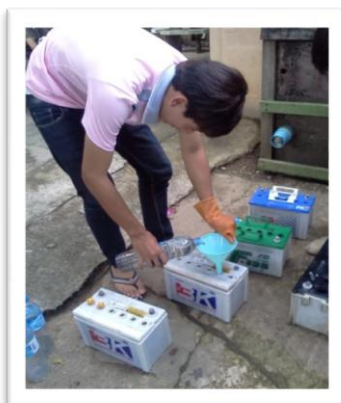
รูปที่ 3.5 แสดงการเทน้ำกรดเก่าลงแบตเตอรี่
