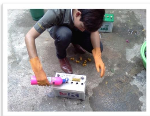
รูปที่ 3.4 แสดงการเทน้ำยาล้างห้องน้ำลงแบตเตอรี่
