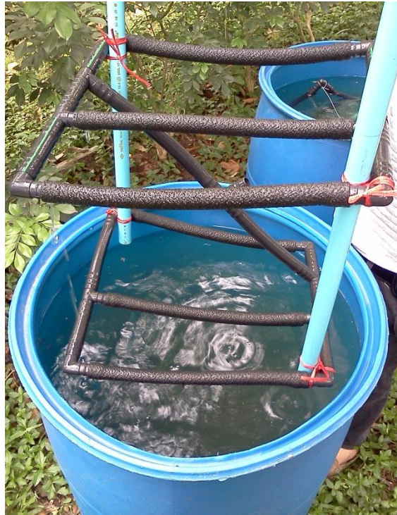
รูปที่ 3.14 รูปการติดตั้งชุดสายยางเติมอากาศแบบขนานแนวนอน
