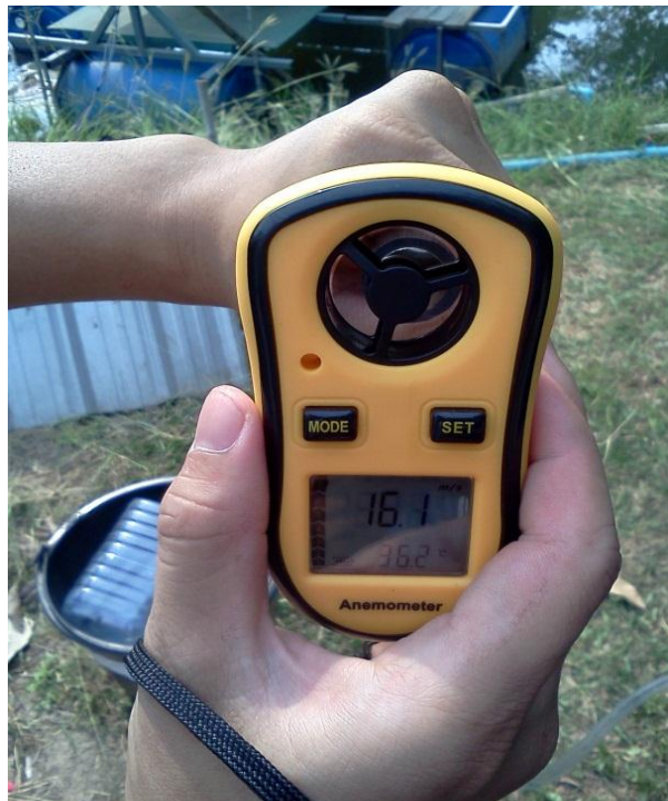
รูปที่ 3.17 รูปแสดงการวัดความเร็วลมโดยเครื่อง Anemometer
