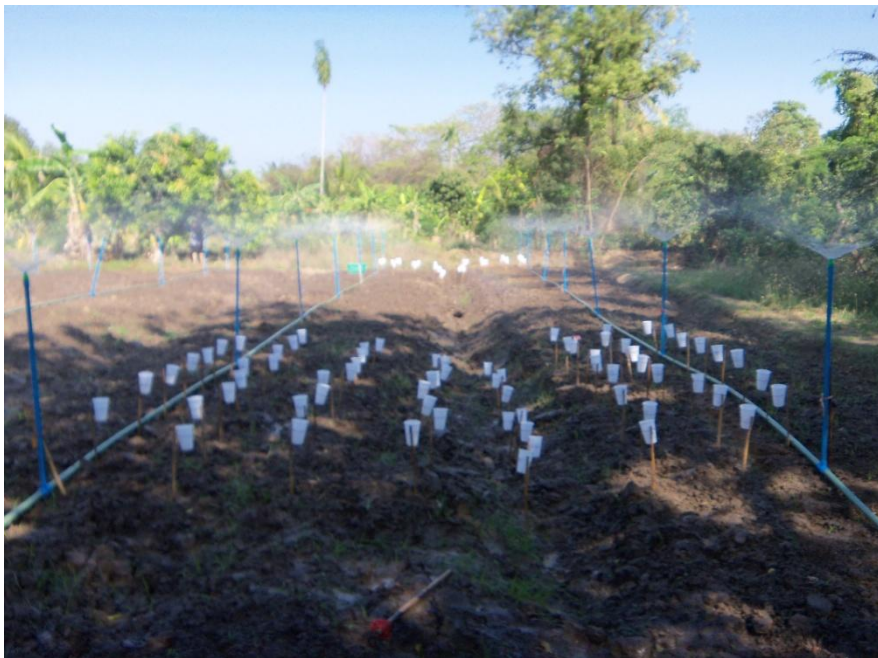
รูปที่ 27 การทดสอบการกระจายของน้ำ โดยวิธี Can Test
