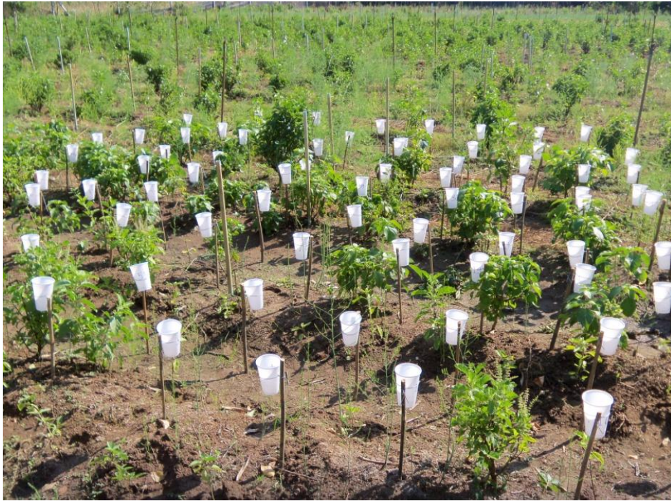
ภาพผนวก ก-23 การทดสอบประสิทธิภาพของระบบสปริงเกลอร์ (หัวจ่ายน้ำเดิมของเกษตรกร) แปลงโหราพา นางสุลักษณ์ ยิ้มเชิง
