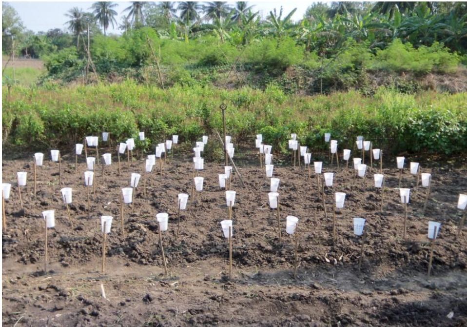
ภาพผนวก ก-14 การทดสอบประสิทธิภาพของระบบสปริงเกลอร์ (หัวจ่ายน้ำเดิมของเกษตรกร) แปลงกระเพาะ พืชพัฒนา กงคี่
