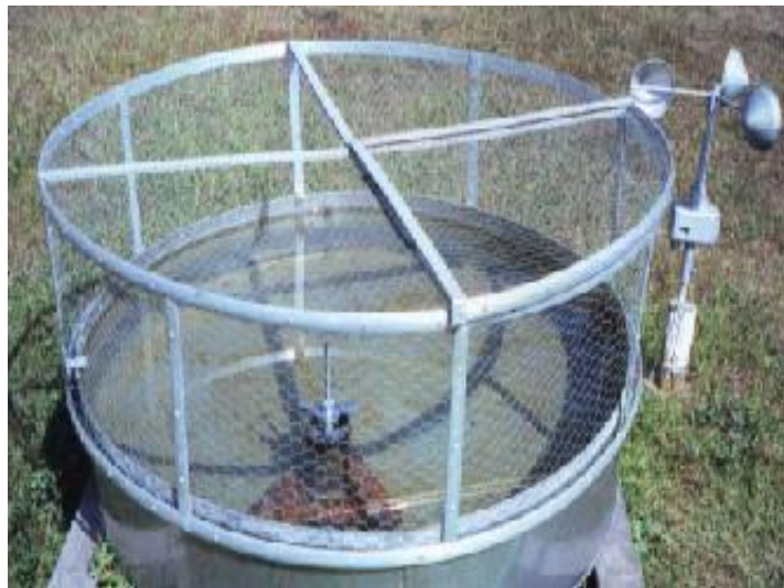
รูปที่ 3 ถาดวัดการระเหยชนิด Class A ที่มา: บุญมา (2546)
