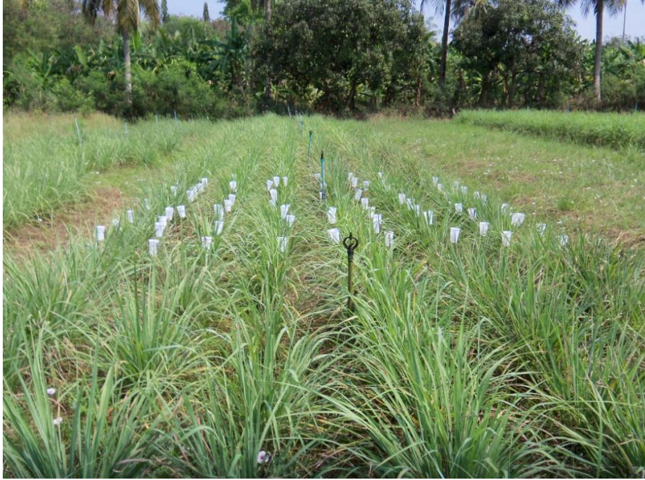
ภาพผนวก ก-19 การทดสอบประสิทธิภาพของระบบสปริงเกลอร์ (หัวจ่ายน้ำเดิมของเกษตรกร) แปลงตะไคร้ นางบุญส่ง วงษ์เลี้ยง
