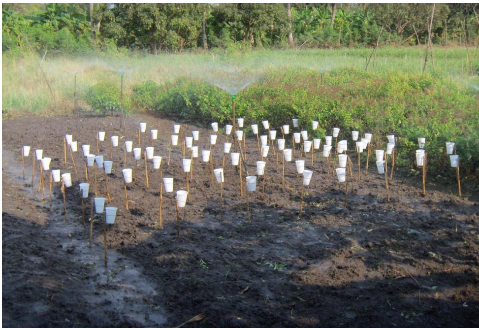
ภาพผนวก ก-15 การทดสอบประสิทธิภาพของระบบสปริงเกลอร์ (หัวจ่ายน้ำชลประทาน 1) แปลงกระเพาะ พืชพัฒนา กงคี่
