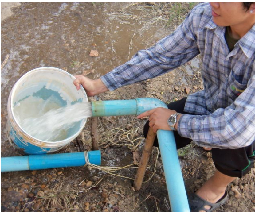
รูปที่ 25 การวัดอัตราการไหลที่ออกจากเครื่องสูบน้ำและการวัดอัตราการไหลจากหัวจ่ายน้ำ
