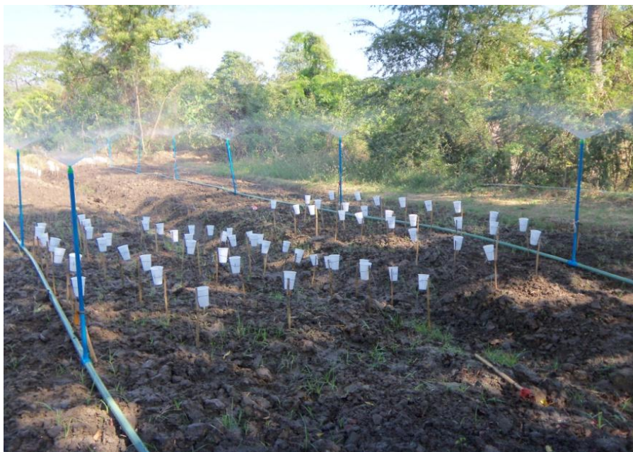
ภาพผนวก ก-10 การทดสอบประสิทธิภาพของระบบสปริงเกอร์ (หัวจ่ายน้ำชลประทาน 1) แปลงผักกาด นางฉวี สวนแก้ว
