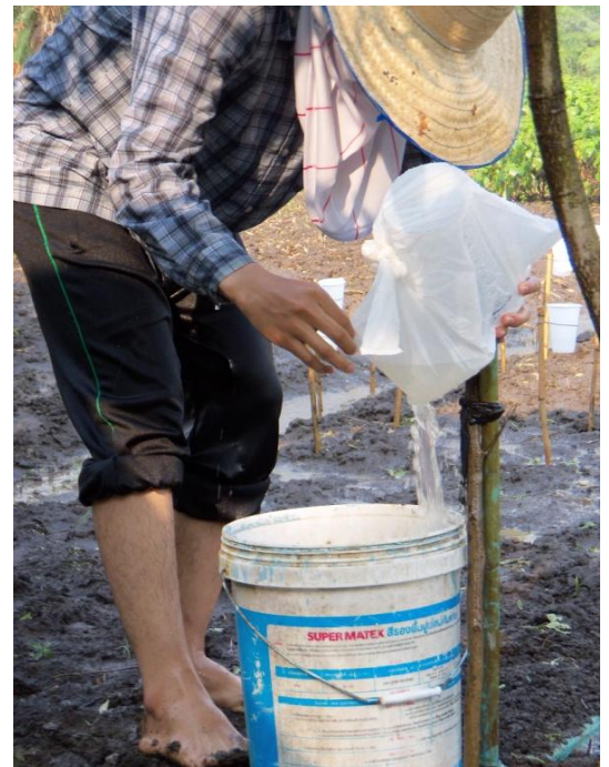
รูปที่ 25 การวัดอัตราการไหลที่ออกจากเครื่องสูบน้ำและการวัดอัตราการไหลจากหัวจ่ายน้ำ
