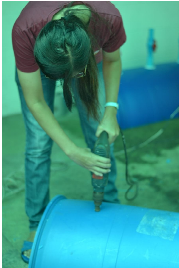
ภาพผนวกที่ ข14 การเจาะรูเพื่อต่อท่อระบายน้ำ
