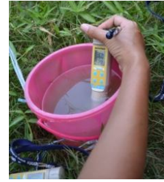
ภาพที่ 1 การทดลองปลูกพืชในภาชนะและการตรวจวัดค่า EC ของน้ำ
