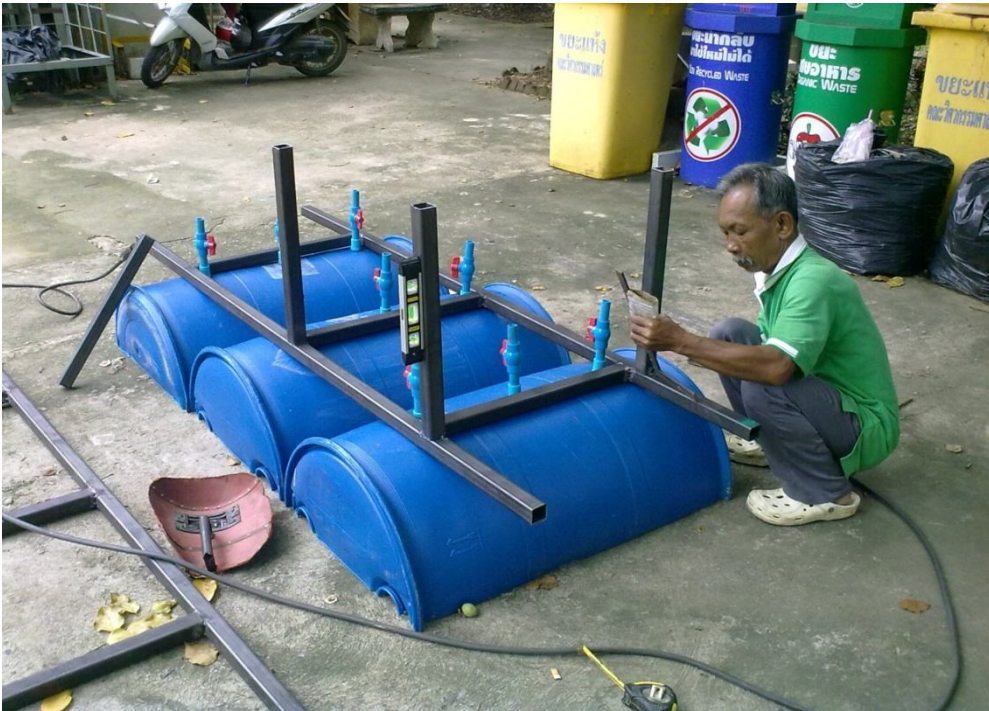
ภาพผนวกที่ ข20 การเชื่อมเหล็กเพื่อทำขารับรางเพาะปลูก
