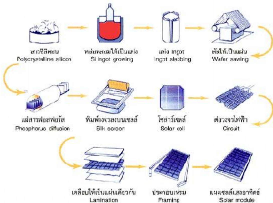
ภาพที่ 1 ขั้นตอนการผลิตเซลล์แสงอาทิตย์แบบผลึกเดี่ยว
