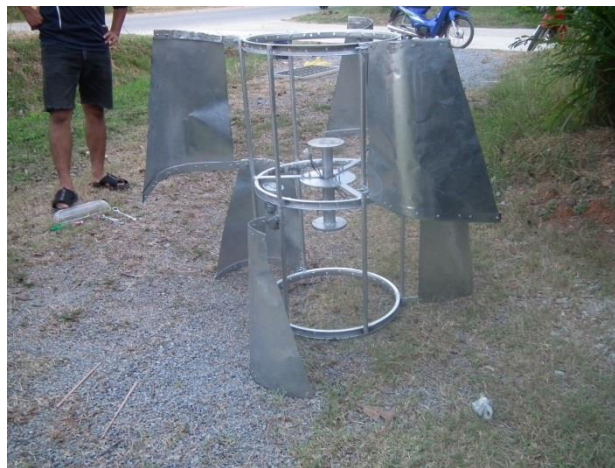
ภาพที่ 3.6 ชุดตลับลูกปืนประกอบเข้ากับโครงกังหัน
