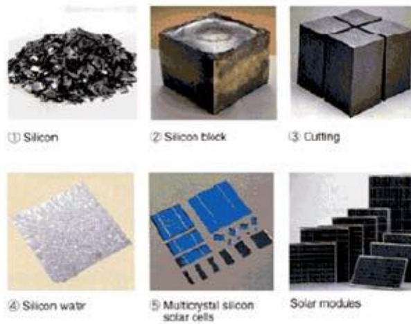
ภาพที่ 3 ขั้นตอนของการผลิตเซลล์แสงอาทิตย์แบบหลายผลึก
