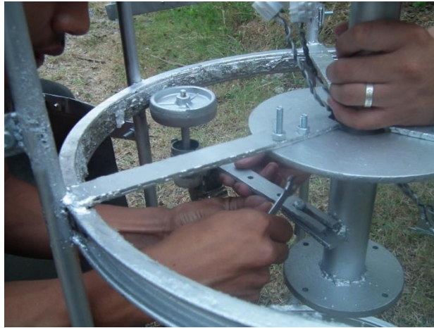
ภาพที่ 3.7 การติดตั้งมอเตอร์ DC และชุดเฟืองทอรอบ
