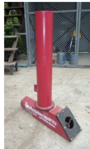
ภาพ ก. ส่วนประกอบของเครื่องตะบันน้ำ
